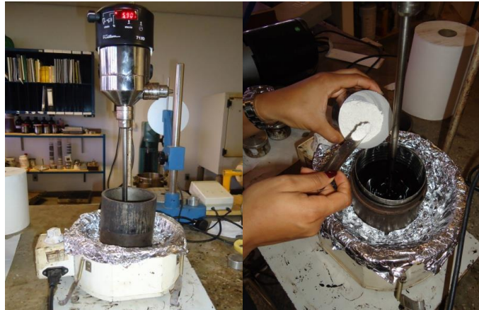
Figura 3.7 – Processo de mistura do gesso ao CAP.
