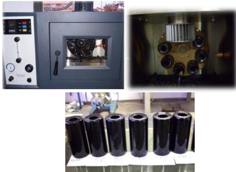
Figura 3.36 – Frascos dentro da estufa de envelhecimento (acima ) e aspecto final do frasco após o ensaio.
