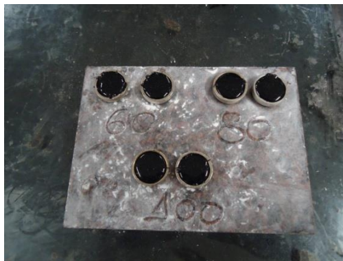
Figura 3.25 – Exemplo de anéis moldados para a determinação do PA.
