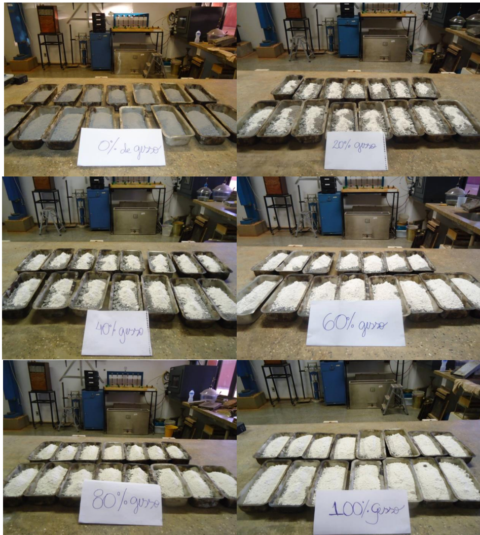
Figura 4.10 – Composições das misturas de referência e com adição de fíler gesso para produção de CPs.
