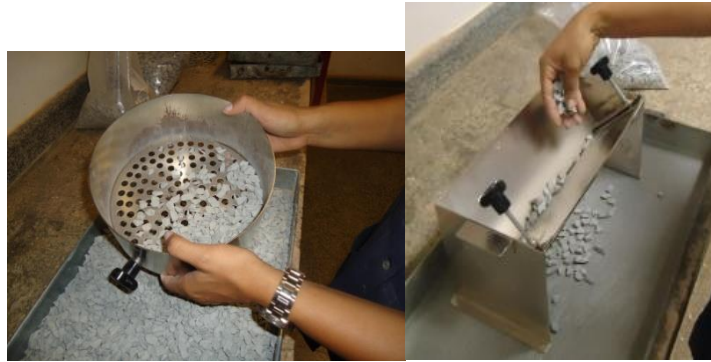
Figura 3.15 – Crivo de abertura circular utilizado para seleção das frações do material (esquerda) e crivo redutor.
