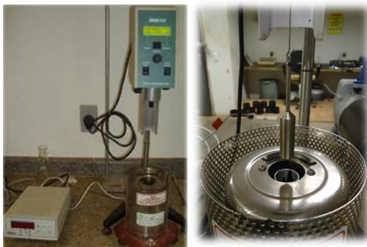
Figura 3.31 – Aparelho Brookfield e detalhe do spindle n°21 preso na haste do aparelho.
