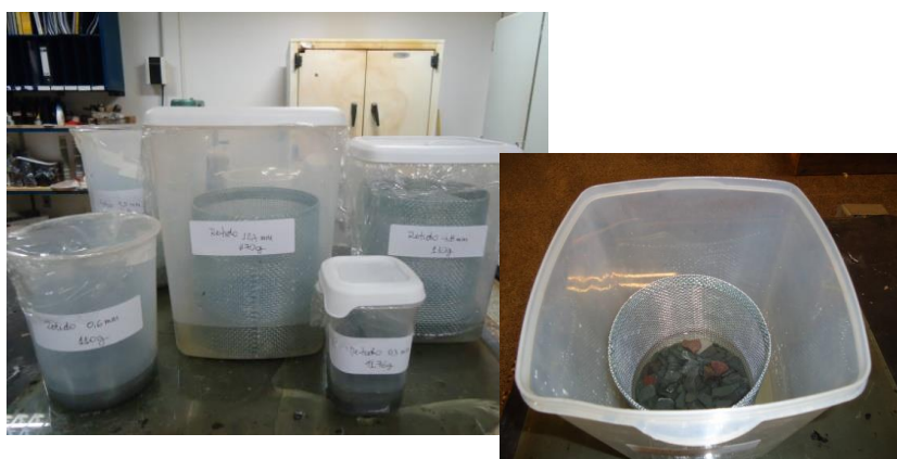
Figura 3.16 – Frações do agregado imersas na solução de sulfato de magnésio; vista de cima do agregado imerso na solução.
