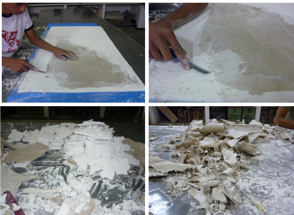
Figura 3.2 - Processo de separação do gesso.
