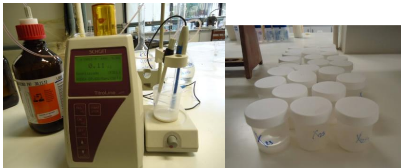
Figura 3.21 – Titulador utilizado para o ensaio de determinação de carga superficial do gesso e amostras em repouso.
