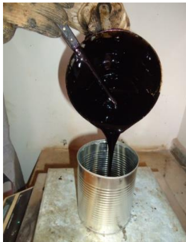
Figura 2.2 – Aspecto da viscosidade do CAP quando aquecido.
