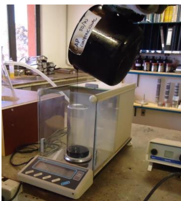
Figura 3.35 – Pesagem dos ligantes no frasco padrão de ensaio para o ensaio RTFOT.
