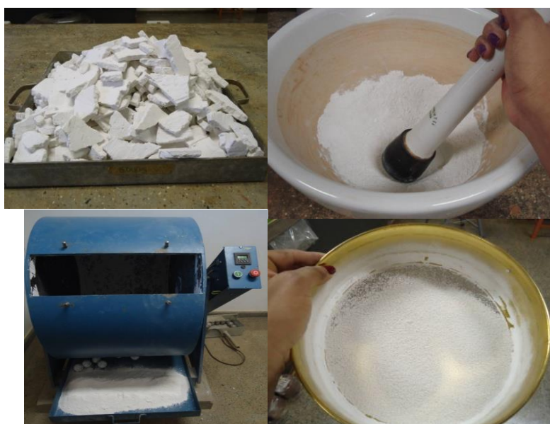
Figura 3.4 – Processo de obtenção do fíler gesso.
