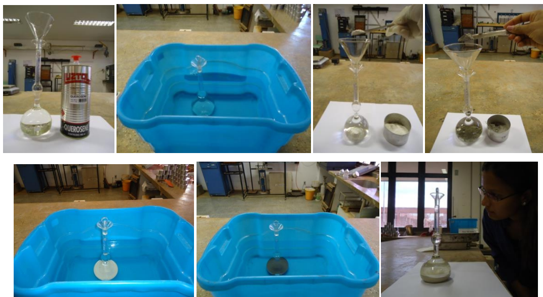
Figura 3.12 – Sequência de procedimentos para a determinação da massa específica real dos fíleres gesso e calcário.
