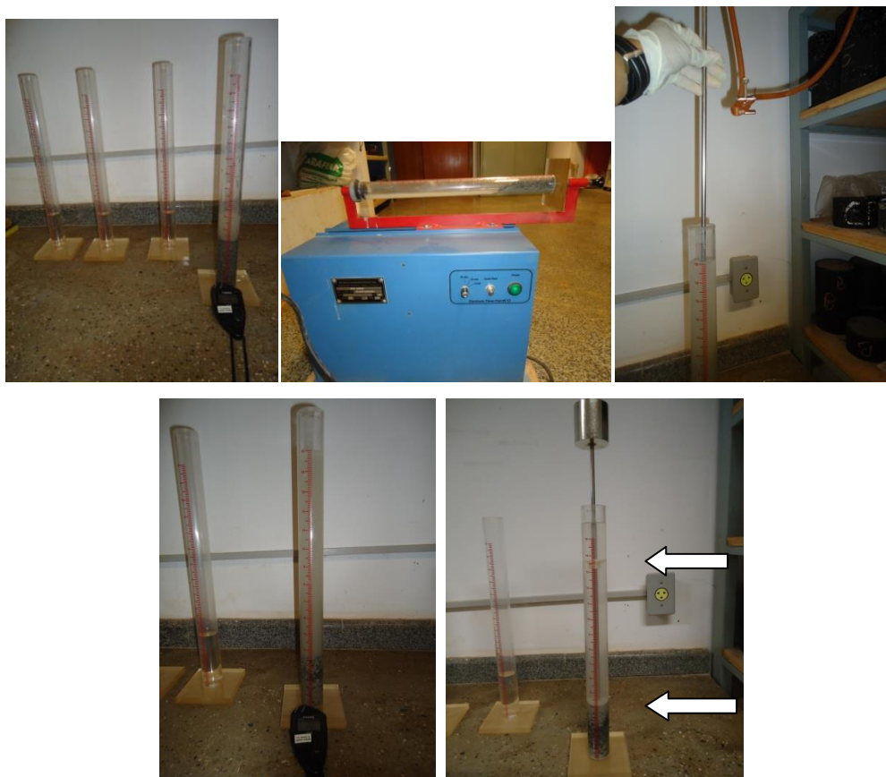
Figura 3.13 – Sequência de procedimentos para o ensaio que determina o equivalente de areia do agregado miúdo.
