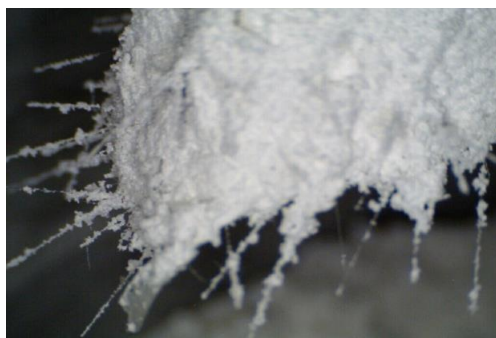
Figura 3.19 – Observação de uma amostra de gesso com o auxílio de microscópio digital, onde é percebida a presença de fibras de vidro.
