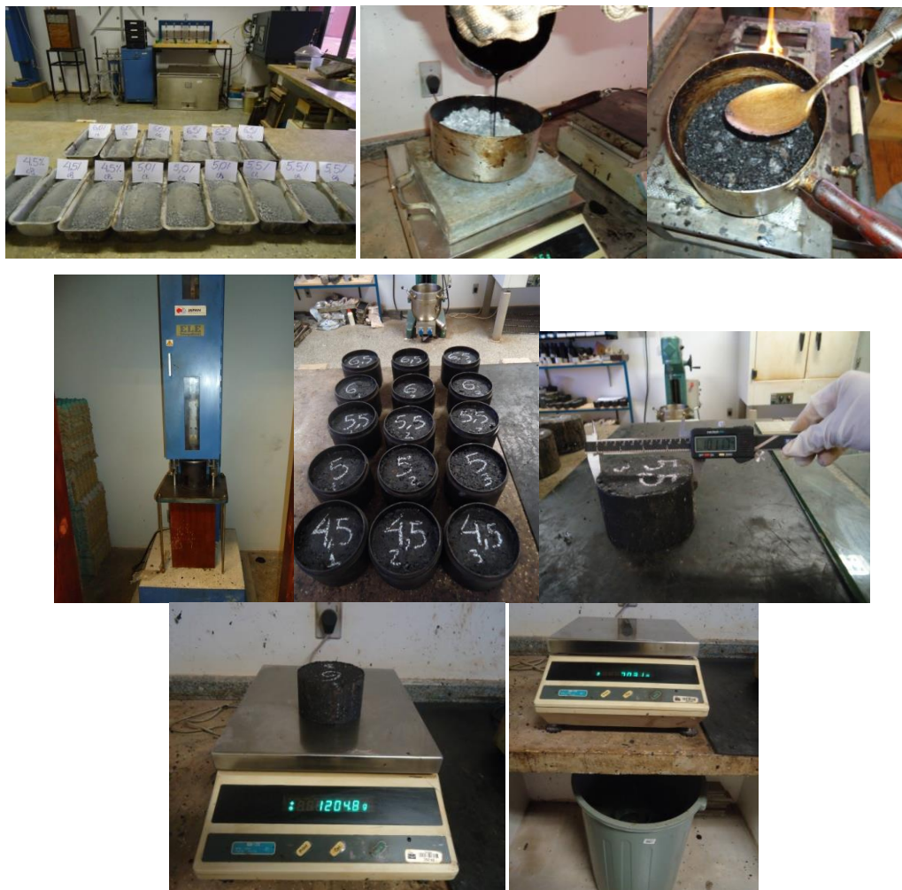
Figura 4.5 – Etapas do processo de dosagem Marshall .
