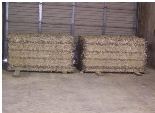
Figura 3.3 – Fardos de papel oriundos das CGA prontos para ser utilizados ( Drywall Recycling Services Inc, 2013 ).
