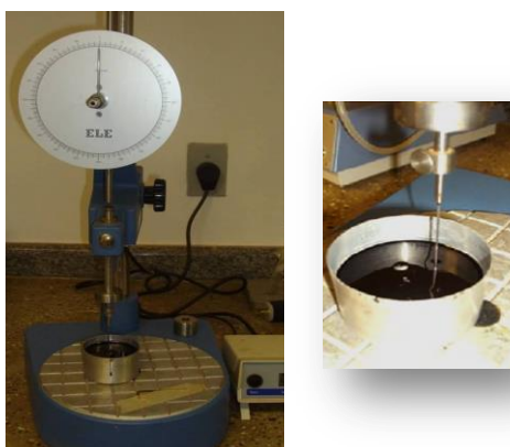
Figura 3.24 – Equipamento utilizado no ensaio de penetração. Detalhe da agulha ao penetrar a amostra.
