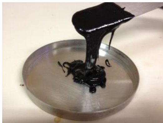
Figura 5.15 – Aspecto da viscosidade do CAP 100% à temperatura de 135°C.
