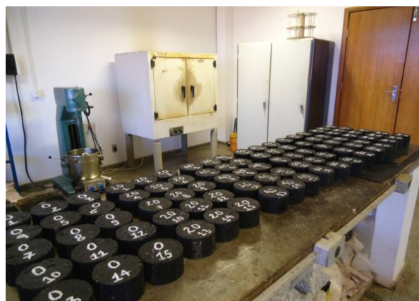
Figura 4.11 – Corpos de prova de CA produzidos, de acordo com as suas respectivas composições.
