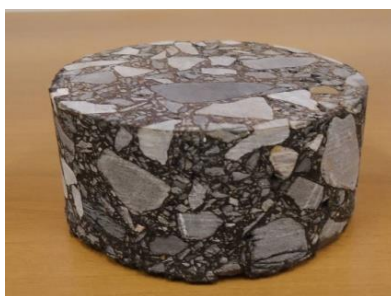
Figura 2.1 – Exemplo de corpo de prova de concreto asfáltico.
