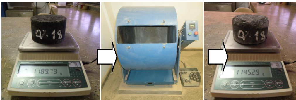
Figura 4.22 – Determinação da massa inicial; processo de desgaste no equipamento Los Angeles e determinação da massa final, após o ensaio.
