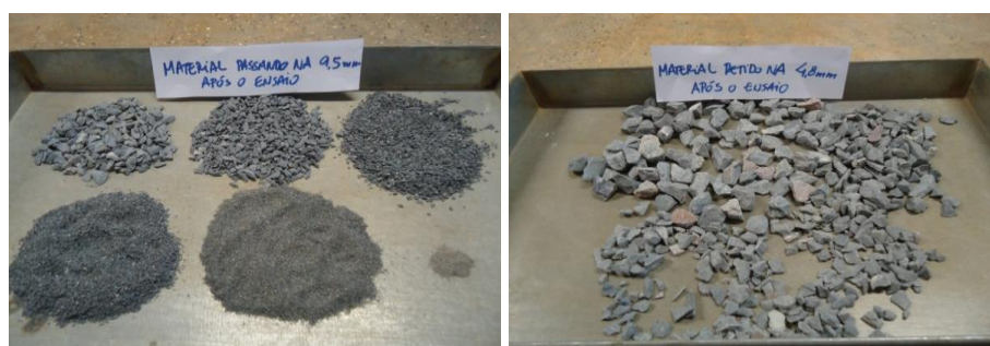
Figura 5.3 – Aspecto dos agregados após o ensaio de durabilidade.
