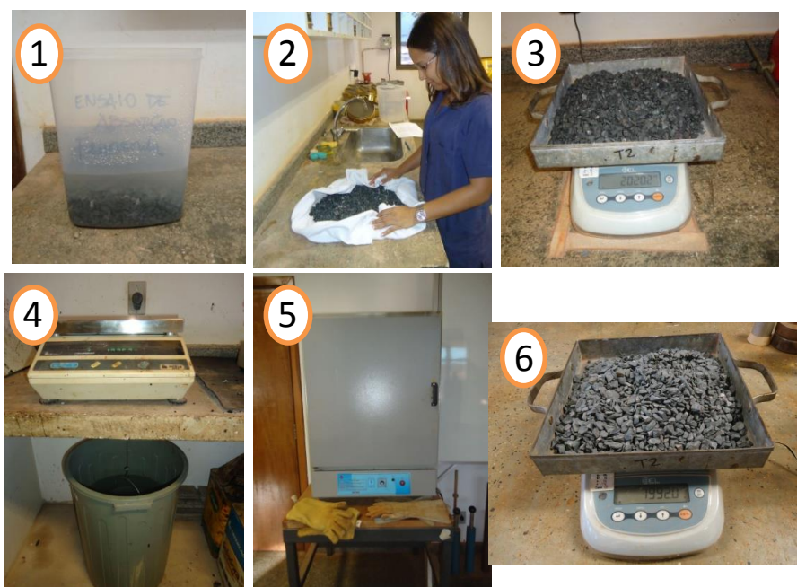
Figura 3.10 – Sequência de procedimentos para o ensaio de determinação das massas específica real e aparente e absorção do agregado graúdo.
