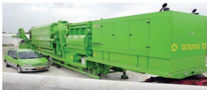
Figura 2.15 - Unidade móvel de reciclagem de resíduos do gesso (HENRIK, 2007).
