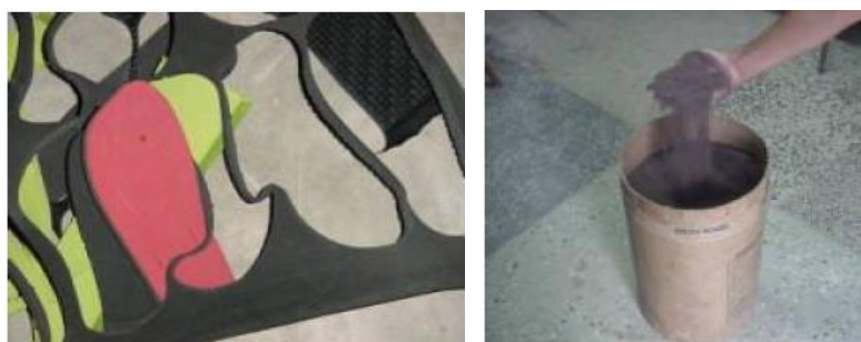
Figura 2.3 – Resíduo de EVA em forma de aparas e em pó oriundos do processo de produção de calçados (ALENCAR, 2005).
