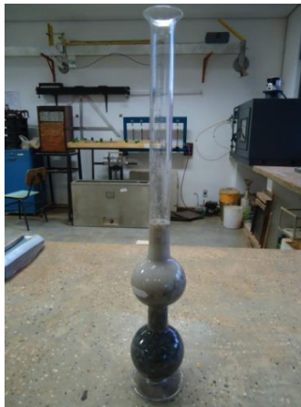
Figura 3.11– Frasco Chapman contendo o agregado miúdo.
