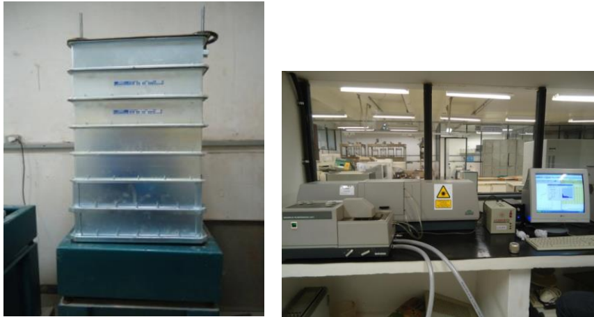
Figura 3.9 – Agitador de peneiras mecânico (à esquerda) e granulômetro a laser .
