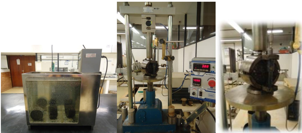
Figura 4.6 - Corpos de prova submersos em banho- maria e equipamento utilizado no ensaio de estabilidade e fluência tendo como detalhe o CP inserido no molde de compressão.
