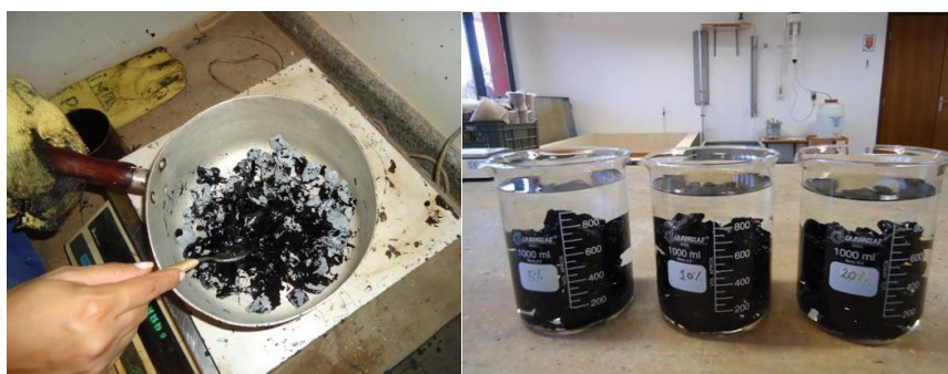
Figura 3.17– Mistura do CAP ao agregado e amostras imersas e água destilada para posterior permanência em estufa.
