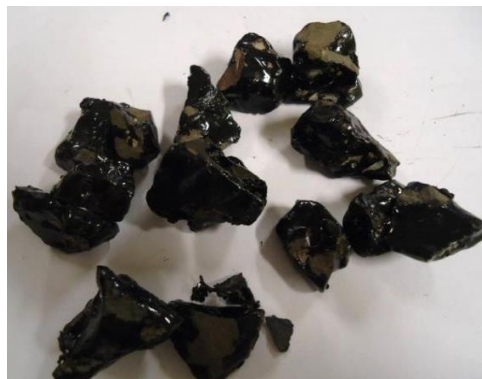
Figura 5.5 - Aspecto dos agregados com a película de ligante deslocada após o ensaio de adesividade.
