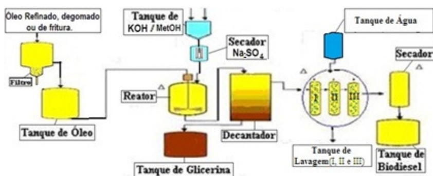
Figura A.8 - Processo de obtenção de biodiesel a partir da transesterificação metílica – Projeto Faculdade do Gama-UnB. Fonte: adaptado de Silva et al. , 2010a.
