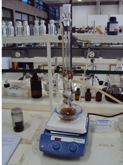
Figura A.10 - Sistema de refluxo para extração de tanino e obtenção de ácido gálico.
