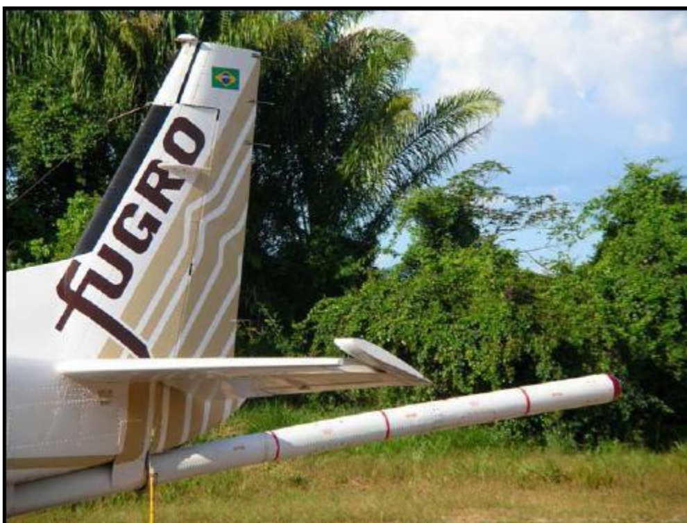
Figura 5-3: A foto mostra o sensor magnetométrico Scintrex CS-2 instalado na cauda da aeronave.
