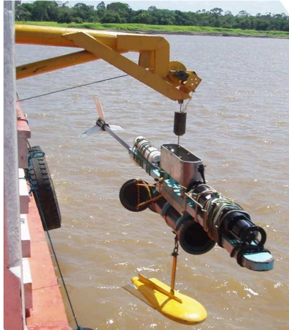
Figura 3.4. Amostrador de fundo Callède I com sonda multiparamétrica e granulômetro laser.
