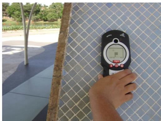
**FIG. 4-5 Pacômetro utilizado na medição (Fonte: Autora)**
