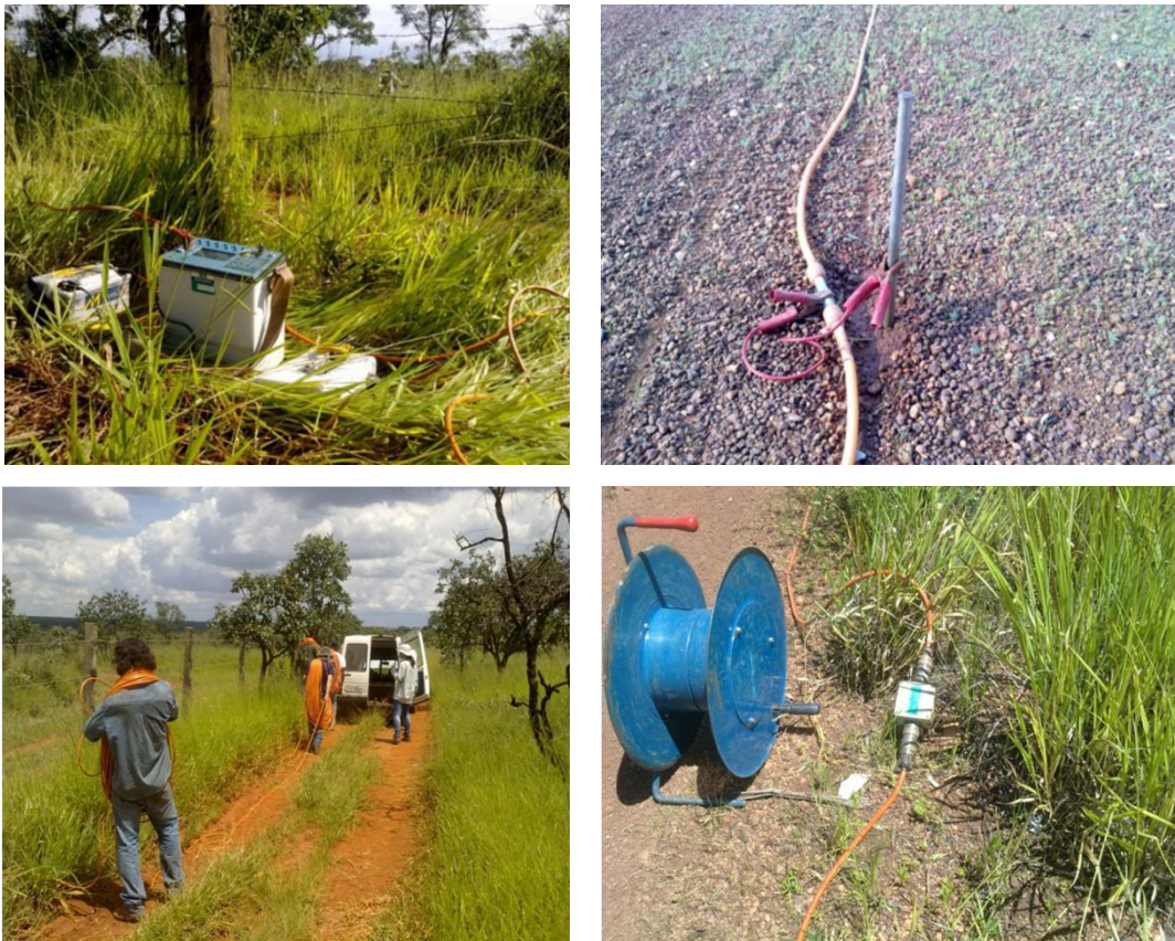
Figuras 5.7 – Fotos evidenciam a aquisição de dados de eletrorresistividade na área externa do Aterro JCB.
