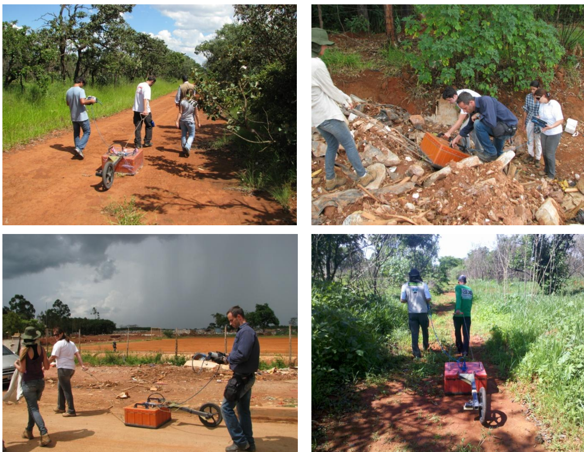
Figura 5.3 – Fotos evidenciam a aquisição de dados de GPR na área externa e interna do Aterro JCB.
