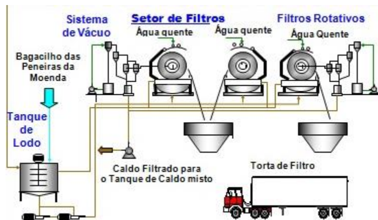
Figura 8 – Fluxograma esquemático do processo de produção de torta de filtro (USINA SANTA ELISA, 2011).
