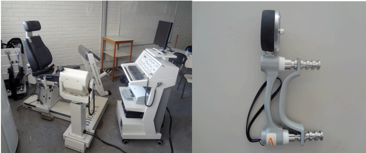
Figura 3 - Dinamômetro isocinético (esquerda) e isométrico (direita).
