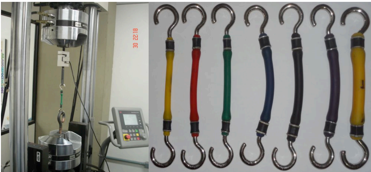
Figura 7 - Foto de um corpo de prova montado na máquina MTS ,mostrando detalhes do ensaio de tração (esquerda). Foto dos corpos de prova utilizados no ensaio mecânico (direita).
