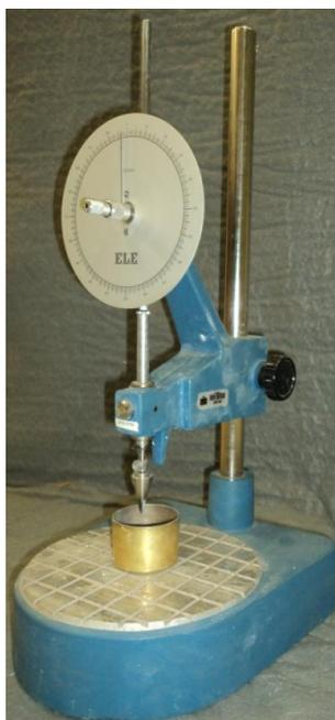
Figura 5.5 Fotografia do equipamento usado no ensaio de cone
