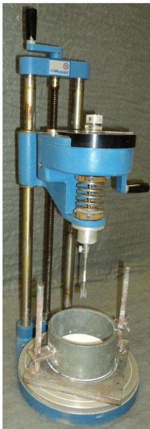
Figura 5.3 Equipamento usado para determinar a resistência não drenada da argila
