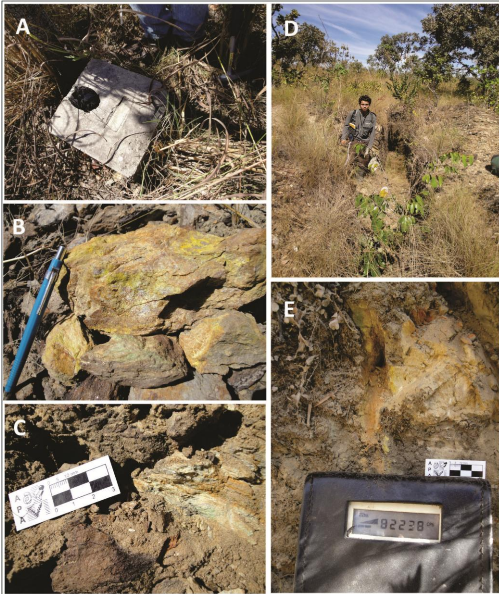
Figura 14. Fotos de campo mostrando mineralizações supergênicas do indício IN001-ANRA, na região do Rio Preto. A) Registro de furo de sondagem realizado na década de 1980 pela NUCLEBRAS (furo 11); B) Aspecto macroscópico de concentrações supergênicas de minerais secundários de urânio; C) Aspecto verde-amarelado de minerais secundários de urânio em trincheira abandonada; D) Visão da trincheira e E) Gamaespectrômetro indicando valores acima de 80.000 cps na mesma trincheira.
