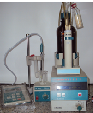
Figura 3.2. Equipamento usado para obtenção da avaliação potenciométrica dos sistemas de Zircônia-íttria.
