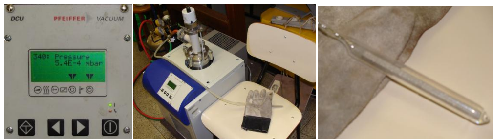
Figura 5.2 Bomba de alto vácuo e cápsula de quartzo com a amostra dentro.
