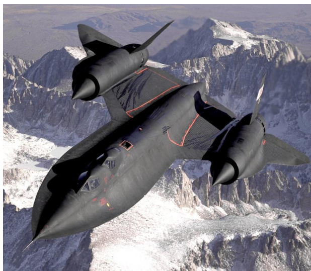
Figura 2.5 Avião SR-71 ( Black Bird ) a primeira aplicação das ligas Ti- \beta em estruturas aeroespaciais (50).
