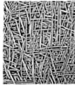
Figura 2.10 Ti-6Al-2Sn-4Zr-6Mo, solubilizado a 955 °C. Acima da temperatura \beta transus. A microestrutura está composta por grandes grãos \alpha (claros) e fase \beta transformada por envelhecimento. Reagente Kroll. 500X (64).
