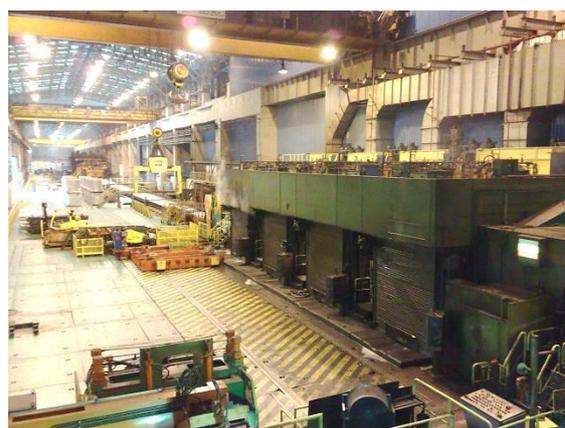
Figura 3.14 – Laminação a quente -laminador Tandem
