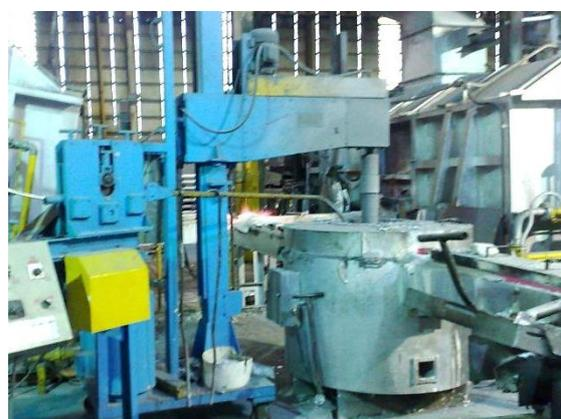
Figura 3.18 – Cadinho elétrico para degaseificação do metal líquido.
