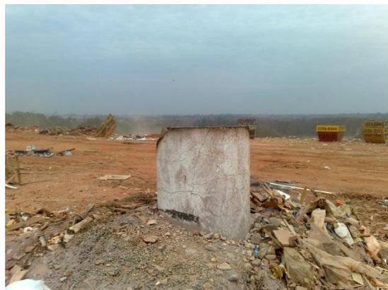
Figura 4.8 – Manilha utilizada na delaminação dos retalhos de ACM
