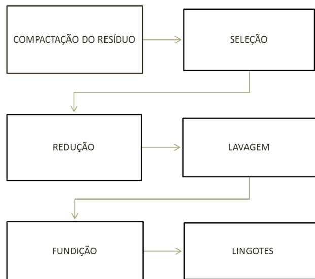
Figura 2.9 – Fluxo esquemático do processo de reciclagem do alumínio (Navarro, 2001)
