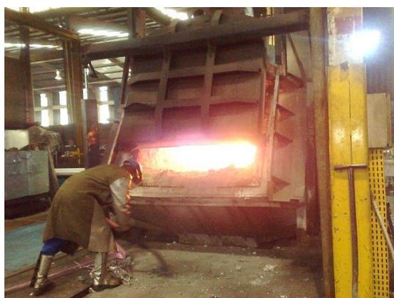
Figura 3.17 - Forno de fusão Reverbero.
