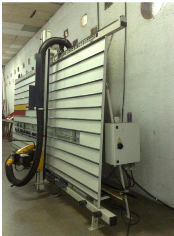
Figura 3.6 – Seccionadora transversal. Maquinário originalmente fabricado para corte de madeira usado na usinagem de painéis de ACM.
