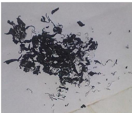
Figura 4.3 – Granulado gerado na fresa dos painéis de ACM
