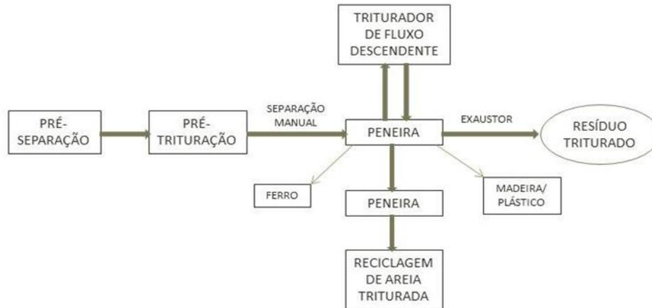
Figura 2.8 – Fluxo esquemático da operação de processamento (adaptado de Hendricks et al., 2000)
