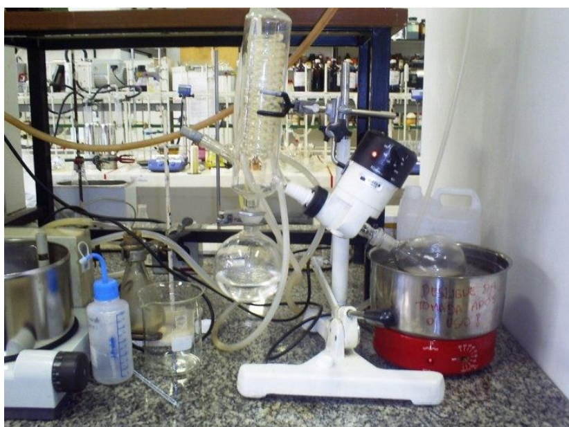
Figura 5.4 Rotoevaporador sob pressão reduzida
