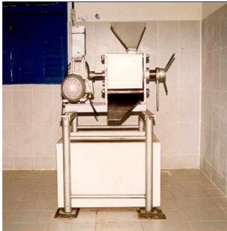
Figura 5.1 Prensa hidráulica para extração de óleos. Fonte: Queiroga, 2011
