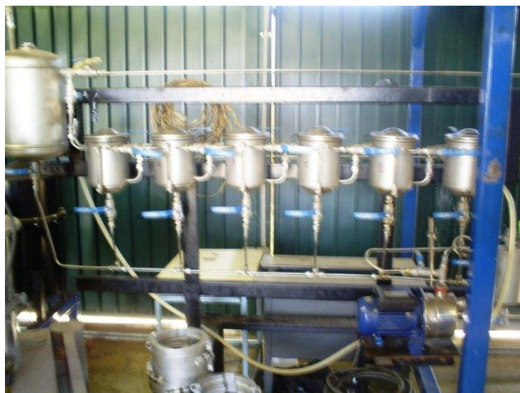
Figura 5.3 Soxhlet semi-industrial (Laboratório de craqueamento térmico. Instituto de química. Unb)
