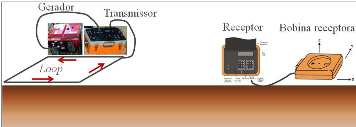
Figura 3.9 - Geometria do sistema ProteM (adaptado de Geonics, 2006).
