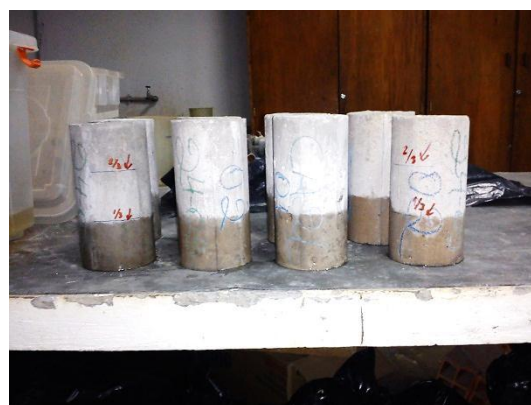
Figura 3.16 – Ensaio de absorção de água: (a) corpos de prova com 1/3 do volume imerso em recipiente com água (1ª etapa da saturação); (b) aspecto dos corpos de prova fora do recipiente.
