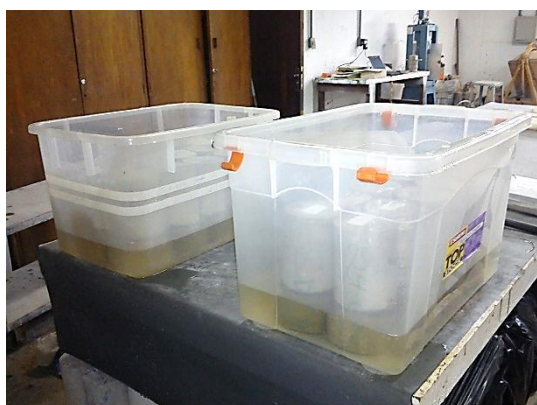
Figura 3.16 – Ensaio de absorção de água: (a) corpos de prova com 1/3 do volume imerso em recipiente com água (1ª etapa da saturação); (b) aspecto dos corpos de prova fora do recipiente.
