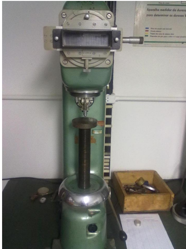
Figura 28. Medidor de Dureza Brinell. Laboratório de Materiais. Universidade de Brasília. Fonte: Autor.
