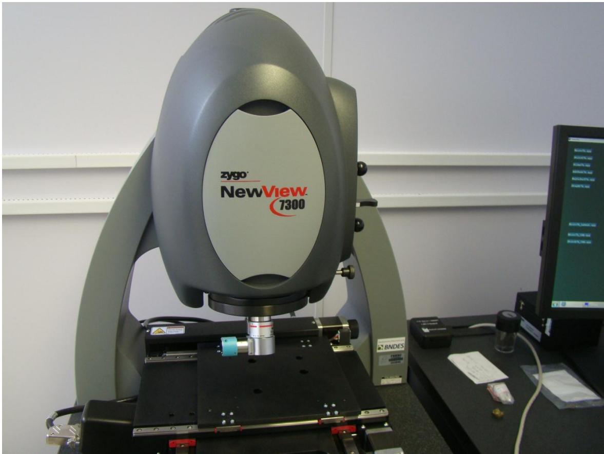
Figura 29. Equipamento para análise por interferometria ótica, Laboratório de Materiais (LABMAT), Universidade Federal de Santa Catarina (UFSC).
