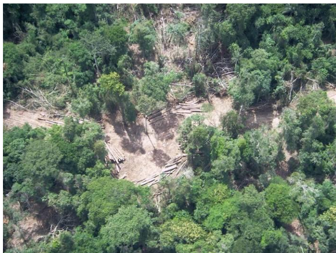
Figura 4.11: - Vista aérea de estradas florestais em Plano de Manejo florestal executado sem acompanhamento técnico, com danos excessivos e sem obedecer ao projeto original
