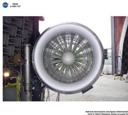
Figura 4.3: Suporte do rotor e do duto com a entrada simples (NASA 1994-01361L)
