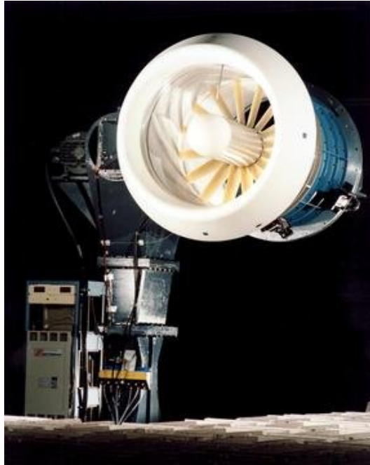
Figura 4.3: Suporte do rotor e do duto com a entrada simples (NASA 1994-01361L)
