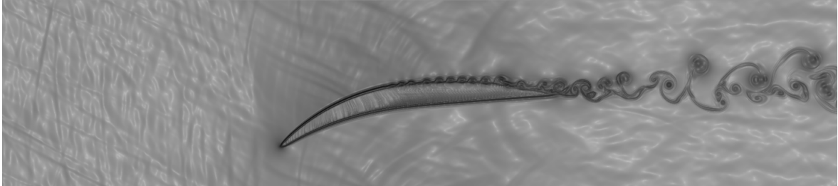
Figura 5.4: Solução do campo de escoamento não estacionário calculado através das equações de Euler não lineares. A variável de visualização é \beta_T = |\nabla T|^{1/20} .
