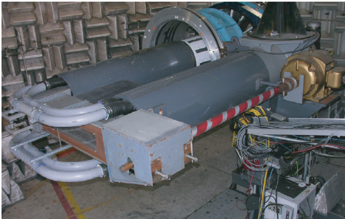
Figura 4.5: Sistema de acionamento do ANCF em detalhe ([Sutliff, 2006])
