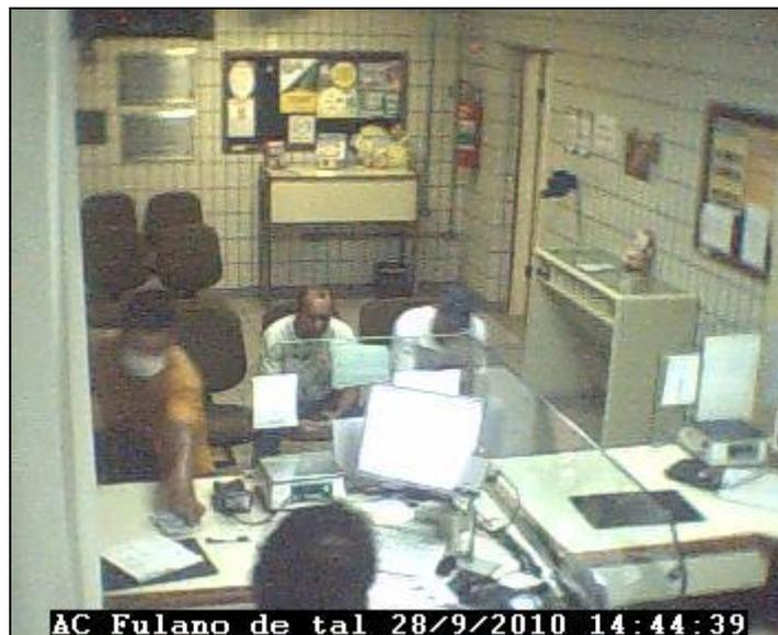
Figura 2.1 – Imagem extraída de sistema de CFTV de agência dos Correios mostrando suspeito de roubo (Resolução 352 X 288 e IPD (distância entre pupilas) = 10,0 pixels). O *motion blur* ocorreu nos quadros em que o suspeito foi flagrado frontalmente pela câmera, mas não está presente em todos os quadros do vídeo. Excesso de movimentos diante da taxa de disparos podem ocasionar efeitos de *blurring* na imagem, o que dificulta o reconhecimento facial.
