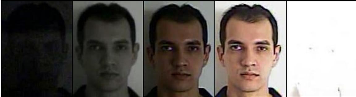
Figura 7.12 – Face capturada com diferentes níveis de iluminância (1 lux / 10 lux / 110 lux / 600 lux / 7100 lux) .
