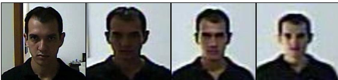
Figura 7.15 – Imagens da face na resolução de 640 x 480 a diferentes distâncias de captura da face (1m / 3 m / 5m / 7m). Todas foram redimensionadas para percepção do nível de pixels na largura da face.
