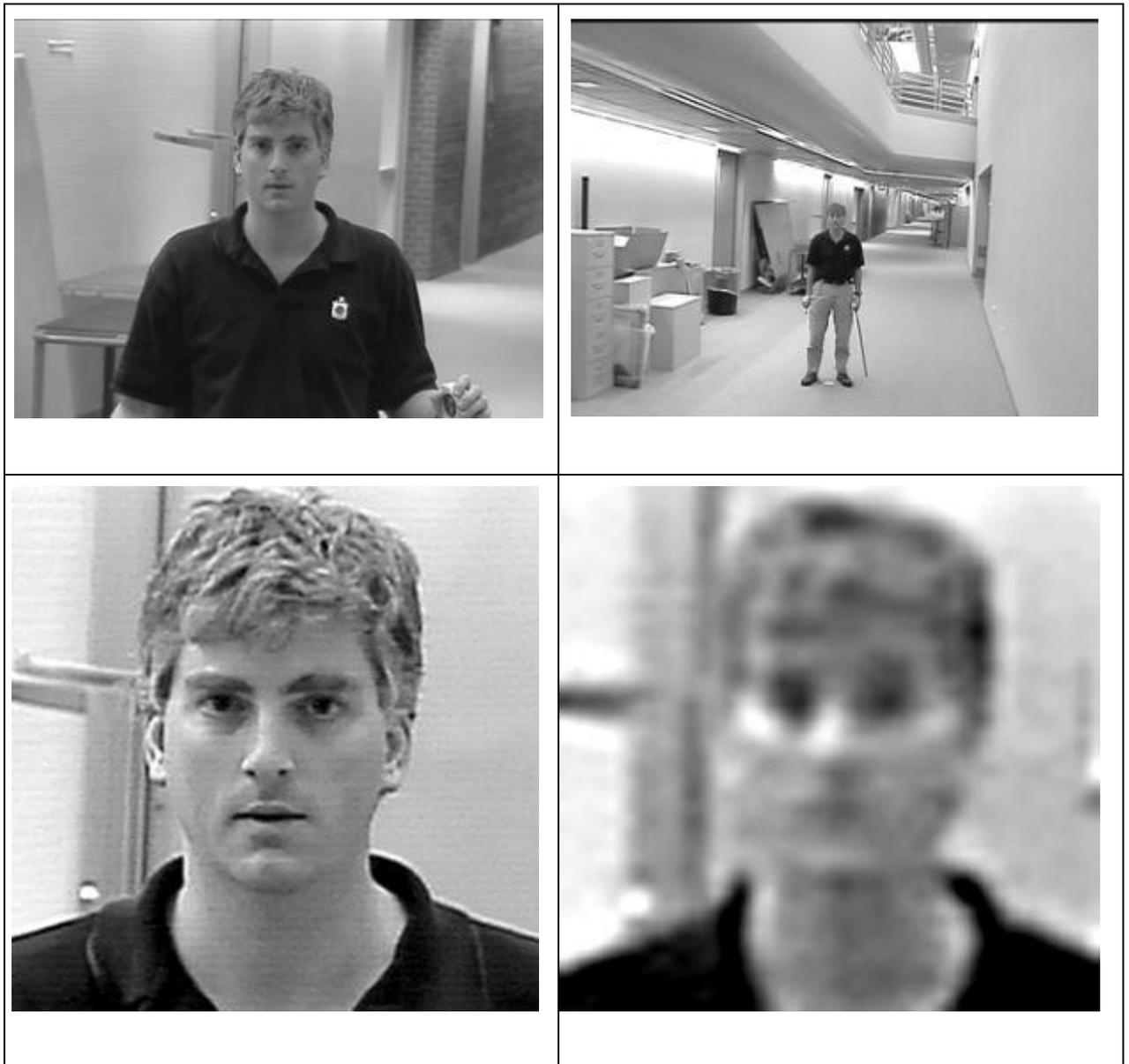
Figura 5.2 – (a) Imagem extraída de sistema de CFTV com características adequadas para reconhecimento facial. (b) Imagem extraída de sistema de CFTV sem condições adequadas para o reconhecimento facial. (c) Imagem da figura (a) processada para focar apenas a face da pessoa na imagem. (d) Imagem da figura (b) processada para focar apenas a face da pessoa na imagem (extraído de (SWGIT, 2004)).
