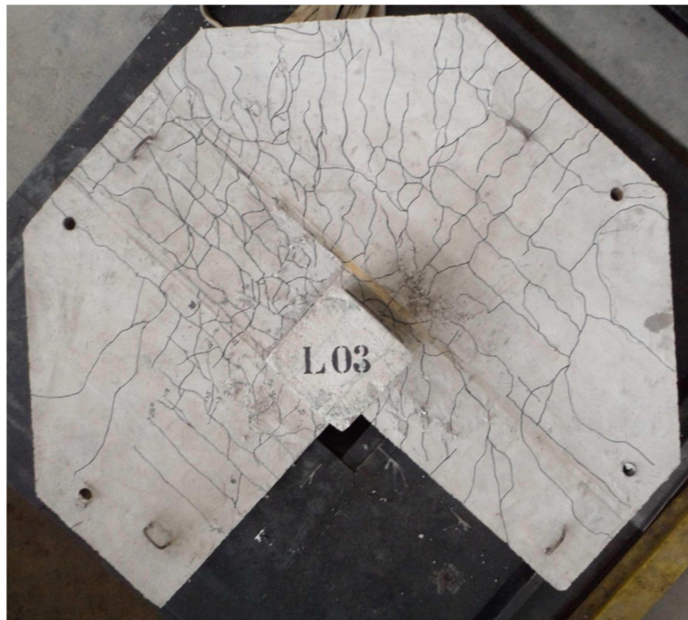
Figura 4.81 - Configuração de fissuras do modelo LC03
