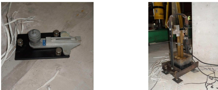
Figura 3.20 - Detalhe dos inclinômetros
