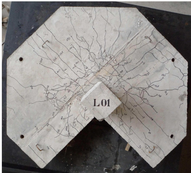
Figura 4.79 - Configuração de fissuras do modelo LR01
