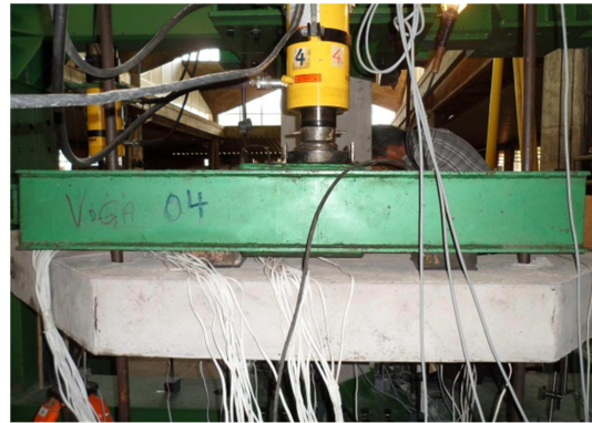
(d) Viga metálica de distribuição
