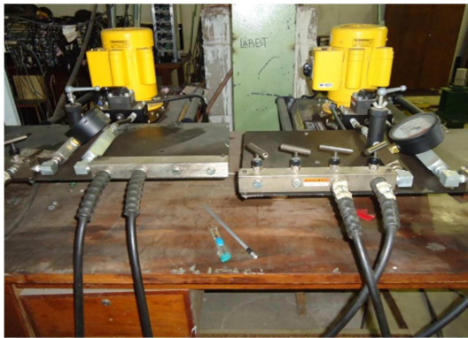
(c) Bombas hidráulicas
