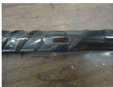
(b) Colagem dos extensômetros
