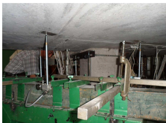
(b) Detalhe dos LVDTs
