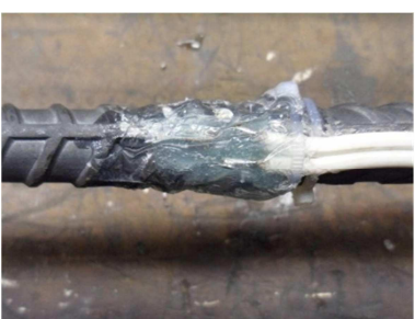
(e) Proteção mecânica com silicone
