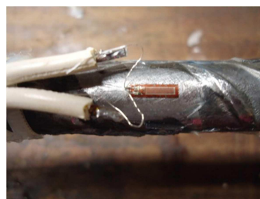
(c) Soldagem dos terminais dos extensômetros
