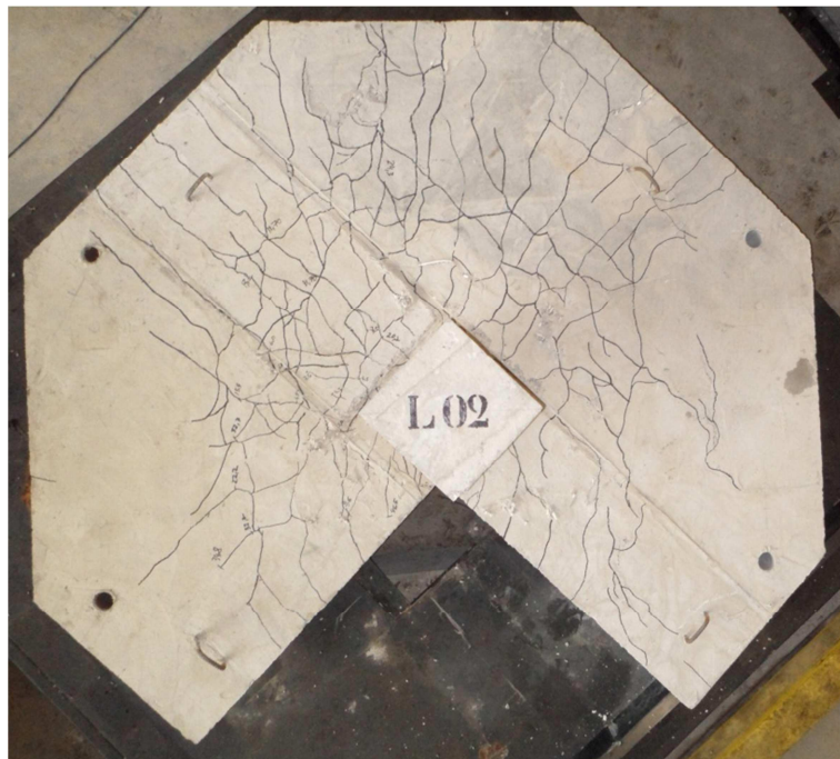
Figura 4.80 - Configuração de fissuras do modelo LC02
