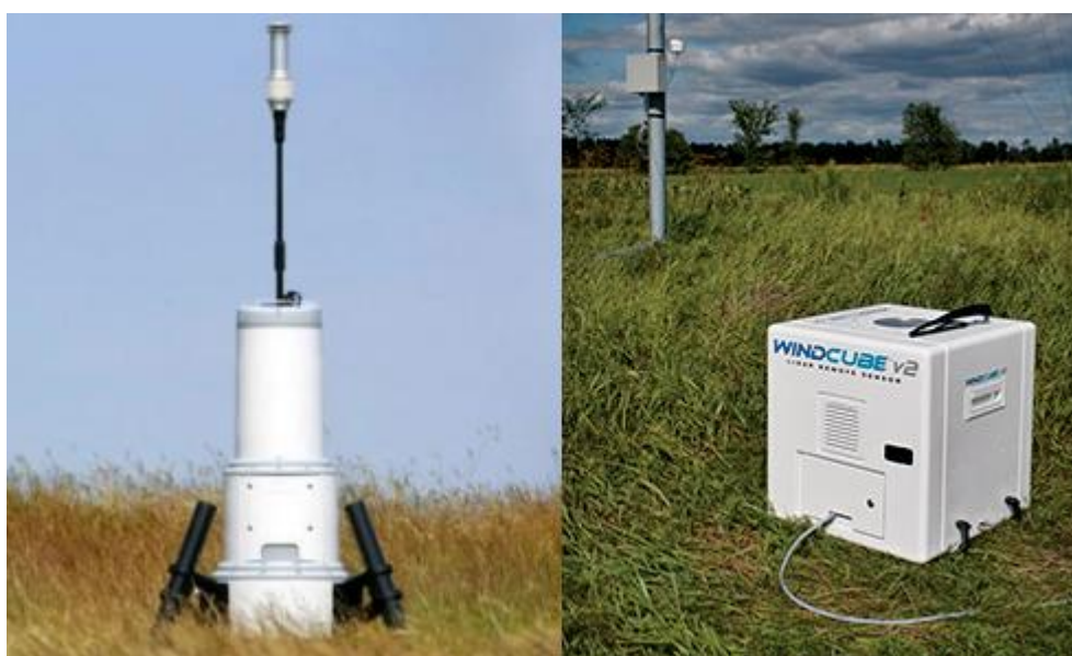
Figura 11: Lidar QinetiQ Zephyr da empresa Natural Power do tipo onda contínua (painel esquerdo) e Lidar Windcube v2 da empresa Leosphere do tipo onda pulsada (painel direito). Fonte: www.naturalpower.com e www.leosphere.com , respectivamente.
