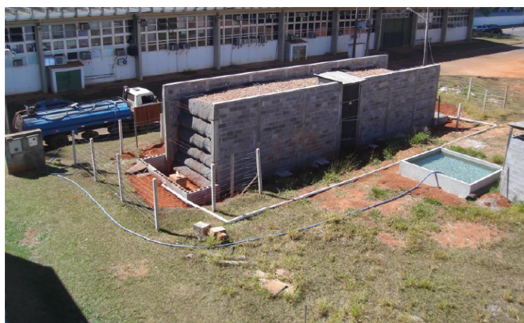
Figura 3.14. Visão geral da inundação induzida do solo de fundação dos muros experimentais (Santos, 2011).
