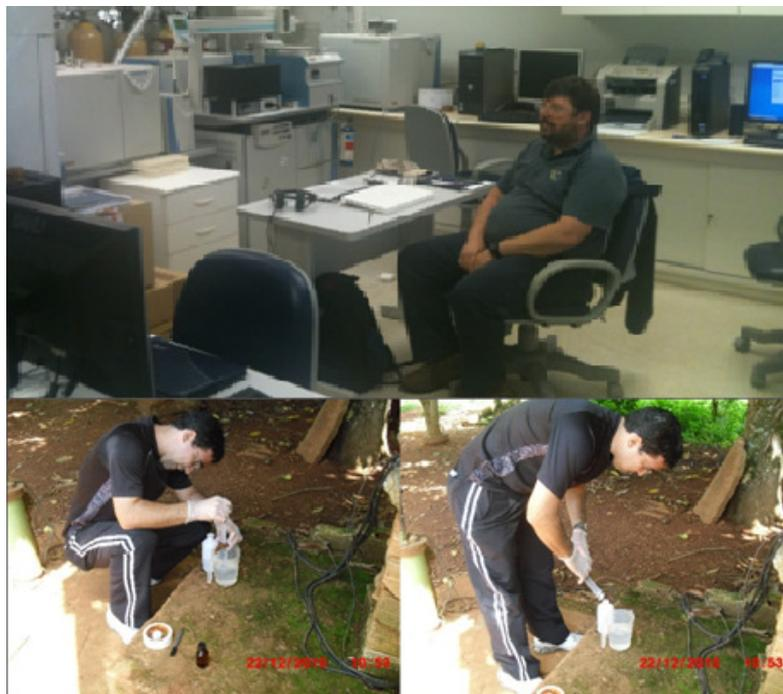
Figura 17 – Acima, sala de análise de isótopos estáveis e abaixo coleta e estabilização de amostra para leitura de razão isotópica de  $\delta^{13}\text{C}$  utilizando filtro de 22  $\mu\text{m}$
