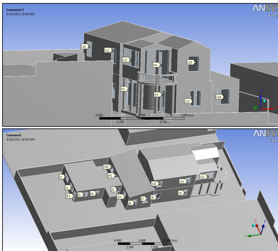
Figura 37 - Identificação das regiões/aberturas da edificação no programa CFX.
