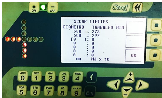
Figura 4.71 - Introdução dos valores limites de energia no Software de monitoramento das estacas hélices.
