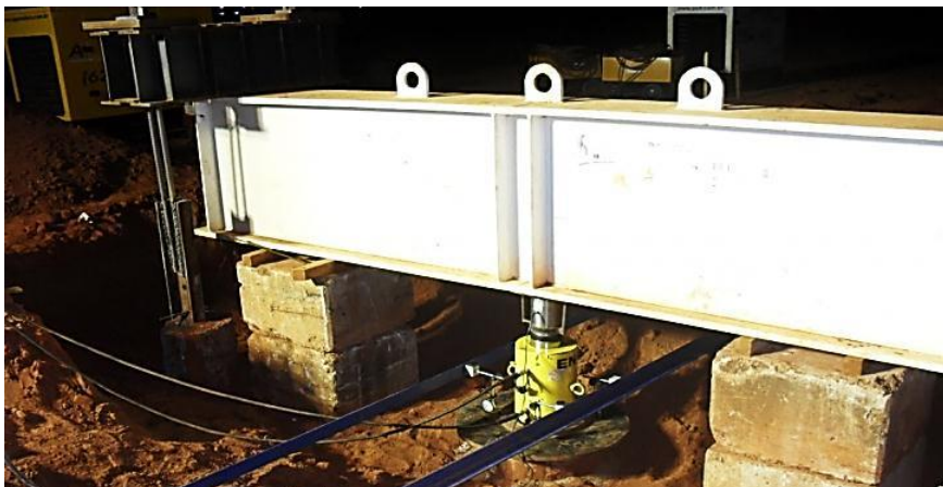
Figura 4.45 – Detalhe do sistema de Reação utilizado nas Provas de Carga.
