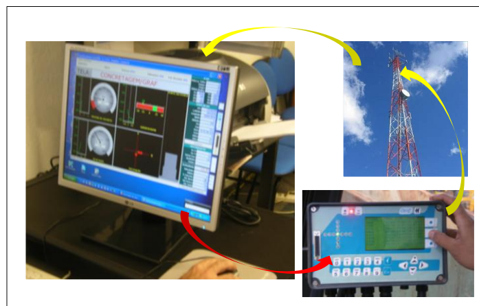
Figura 4.73 – Telemonitoramento da execução através da tecnologia GSM.
