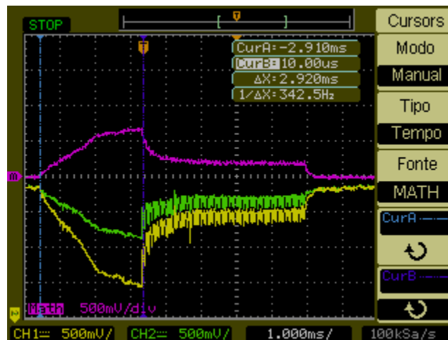
Figura 44: Perfil de corrente no bico injetor de GNV (em rosa) – repare que a corrente durante o hold estabiliza em aproximadamente 34% da corrente máxima durante o peak.
