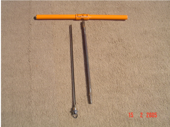
Figura 5. Componentes do Trado de Pressler
