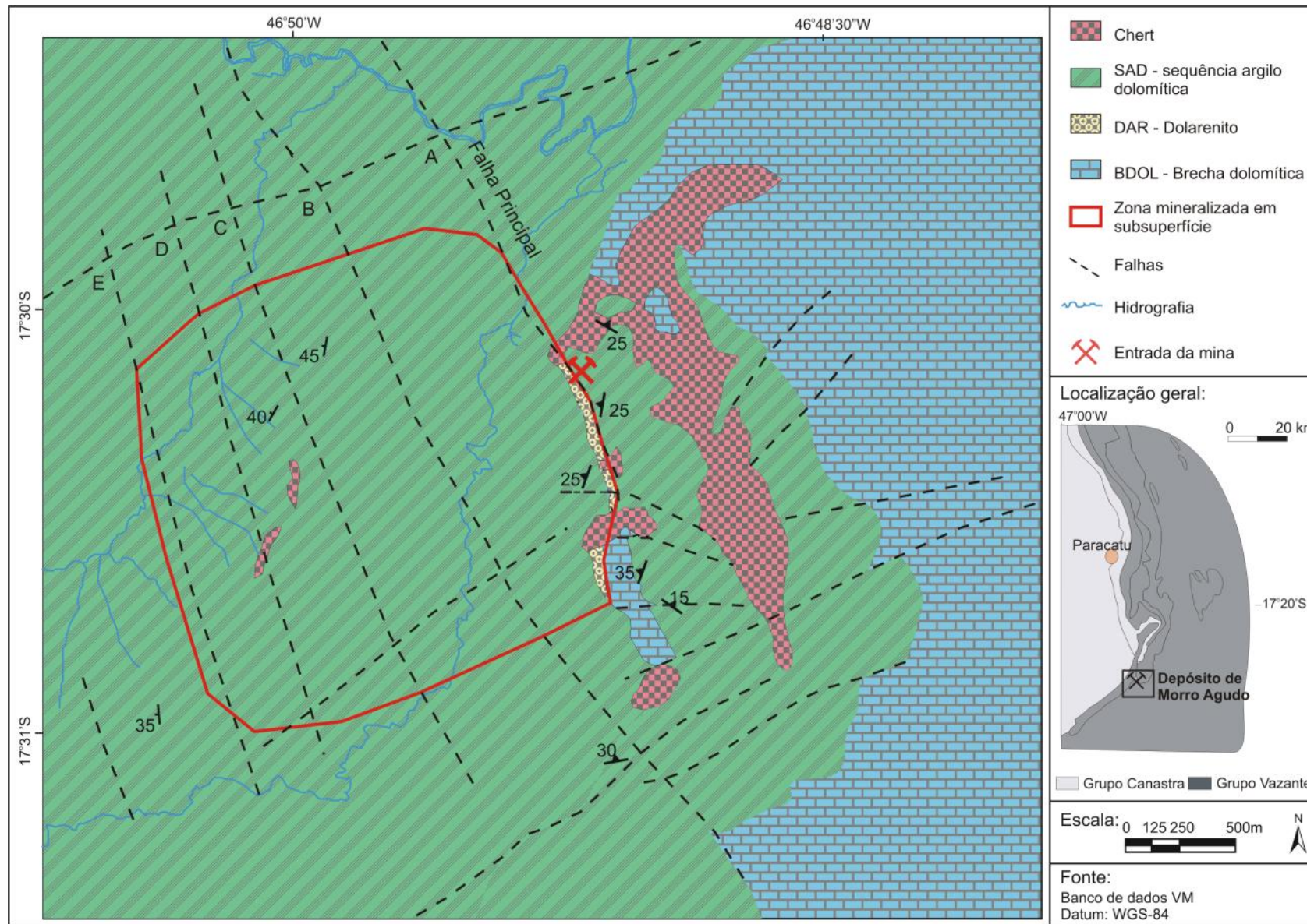
Figura 1.8 – Mapa geológico local, produzido neste trabalho, representando a disposição das falhas (Principal e as divisoras de blocos – A, B, C, D) na região.
