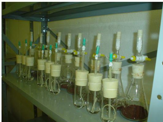
Figura 4.4: Respirômetros incubados no interior da sala com controle de temperatura.
