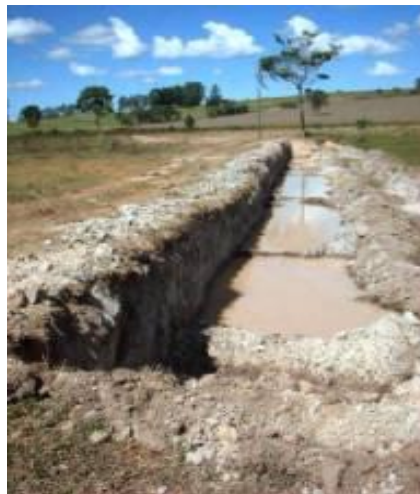
Figura 2.16 - Extração da argila utilizada na fabricação de blocos cerâmicos (Spoto, 2007)
