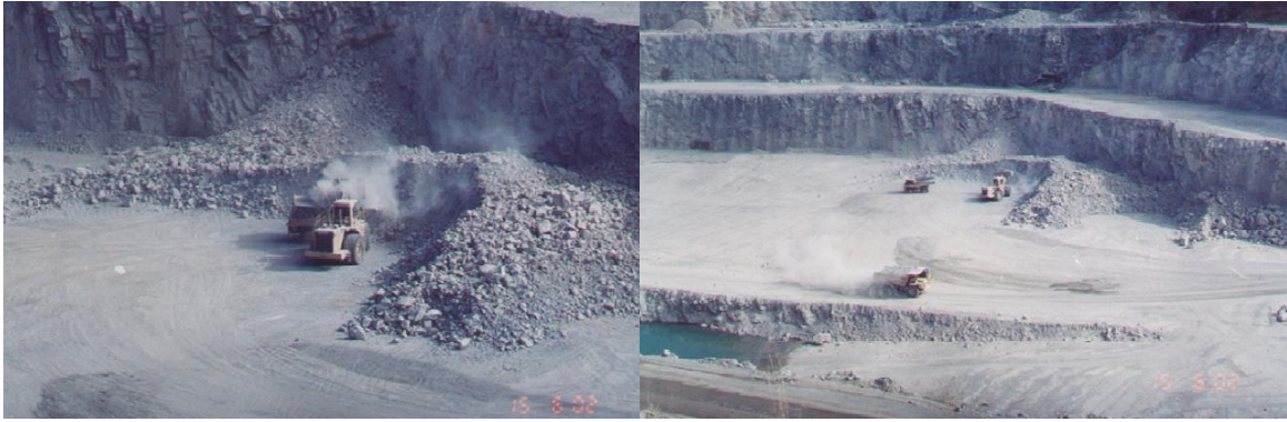
Figura 2.14 - Extração do calcário utilizado na fabricação do cimento Portland (Silva, 2002)
