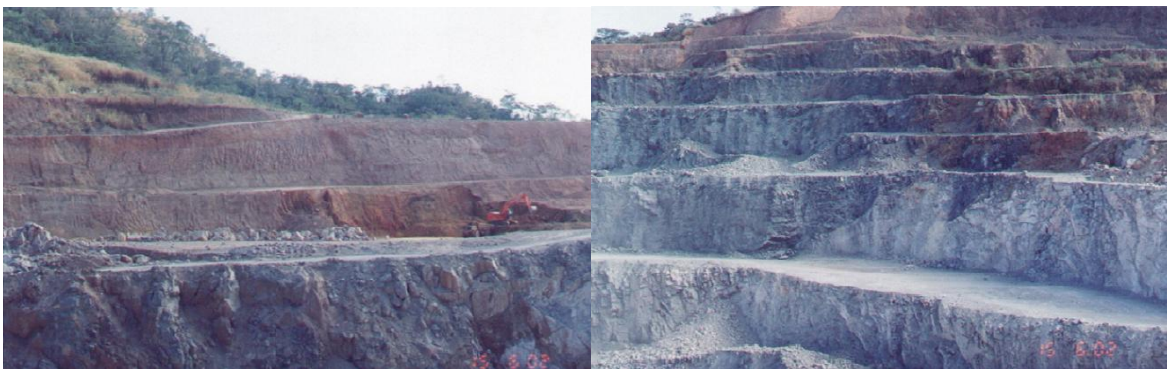
Figura 2.15 - Extração da argila utilizada na fabricação do cimento Portland (Silva, 2002)
