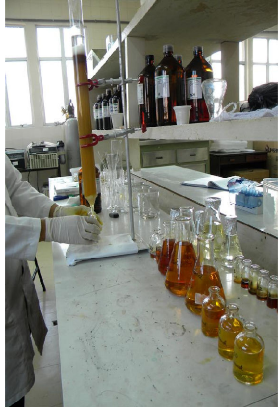
Foto 10 e 11 – Laboratório de Fitoquímica, Cromatografia de Coluna
