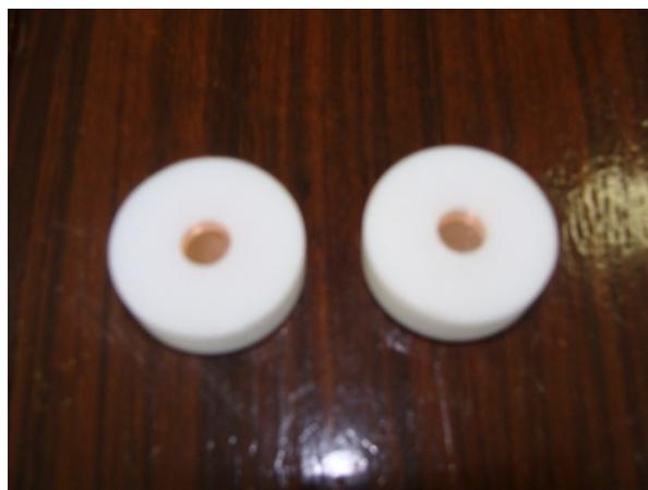
**Figura 21.** Discos de Cu inseridos nos suportes de Teflon.
