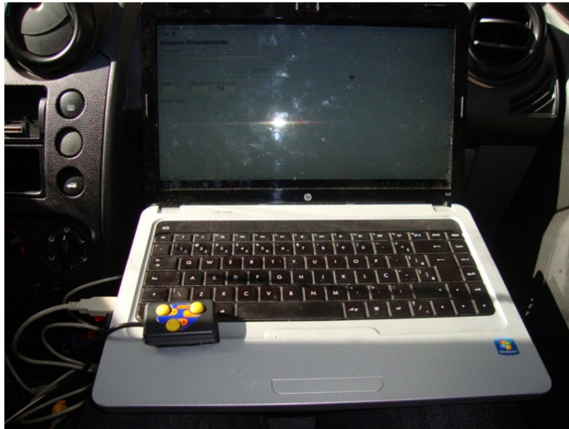
Figura 6.7: Conexão do equipamento ao computador e visualização do controle
