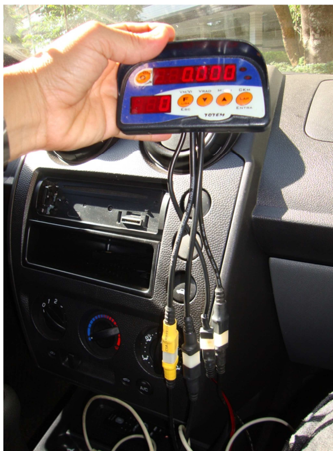
Figura 6.6: Ligação dos sensores com o equipamento
