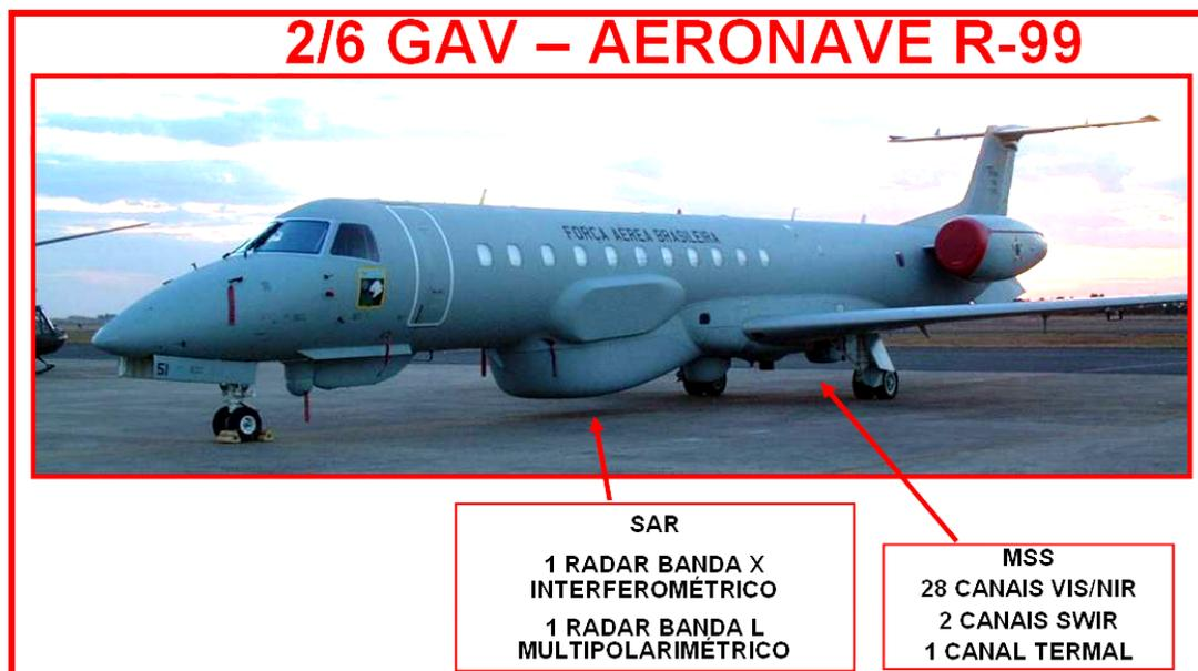
Figura 5.4: Aeronave R99 com os sensores SAR e MSS. Fonte: COMGAR (2010).
