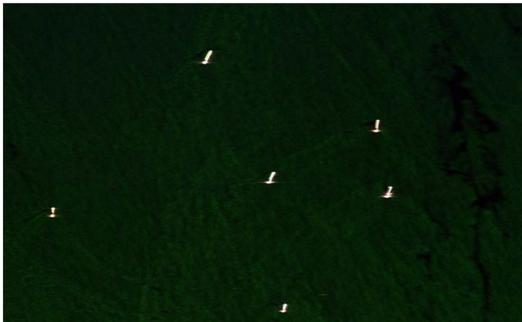
Figura 5.2: Imagem SAR da região do Porto de Tubarão, obtida na banda L e polarizações HH, HV e VV, contendo embarcações mercantes. Fonte: COMGAR (2010).
