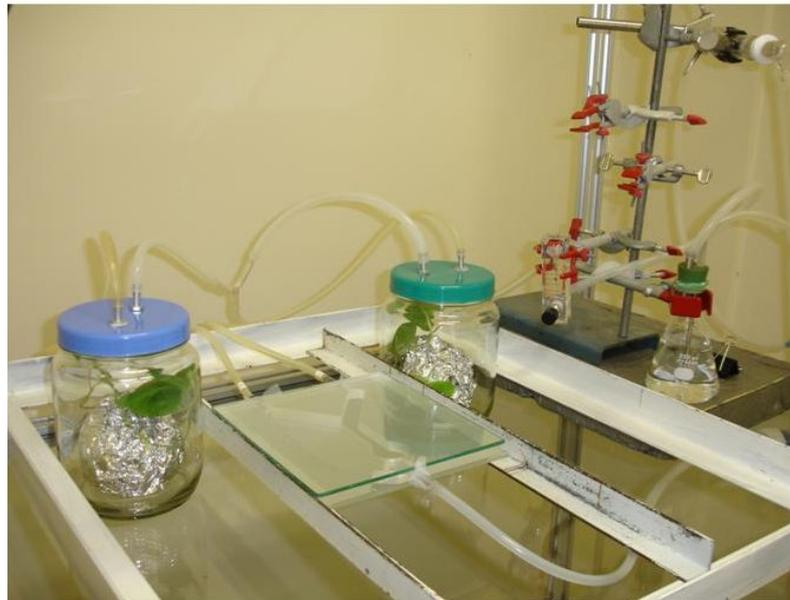
Fig. 1. Sistema de bioensaio com o olfatômetro em forma de “Y” utilizado no Laboratório de Semioquímicos – Empresa Recursos Genéticos e Biotecnologia (Cenargen), Brasília, DF.
