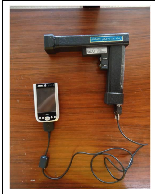
Figura 3.12 – Aparelho para medição de susceptibilidade magnética, Hand–Held Conductivity & Magnetic Susceptibility Meter DDD MPP-EM2S+Multi Parameter Probe .
