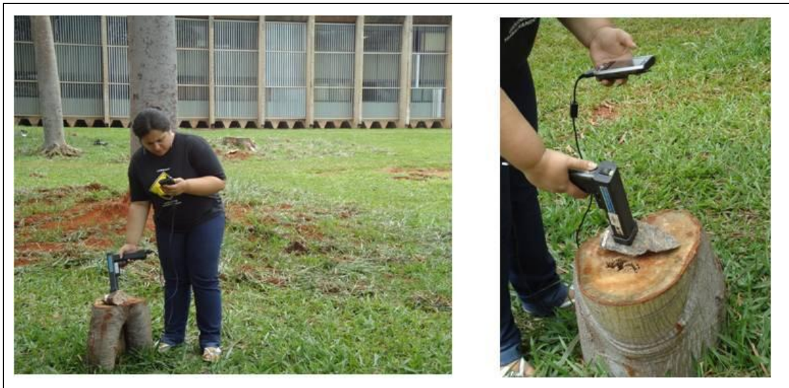
Figura 3.11 – Medidas de susceptibilidade magnética realizadas em amostras de afloramento do Complexo Alcalino Fazenda Buriti e do Complexo Alcalino Diorama. O aparelho utilizado foi o Hand-Held Conductivity & Magnetic Susceptibility Meter DDD MPP-EM2S+Multi Parameter Probe , desenvolvida pela GDD Instrumentations Inc.
