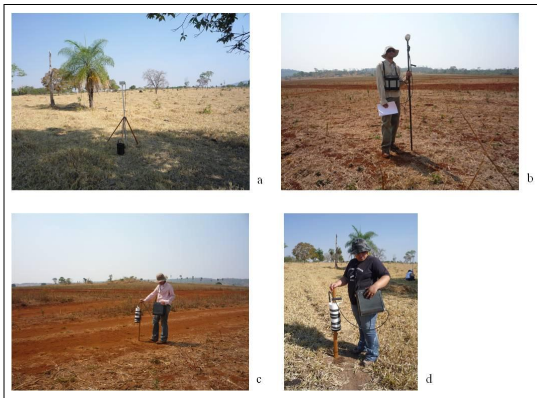
Figura 3.10 – (a, b) Levantamento magnetométrico e (c, d) gamaespectrométrico terrestre.
