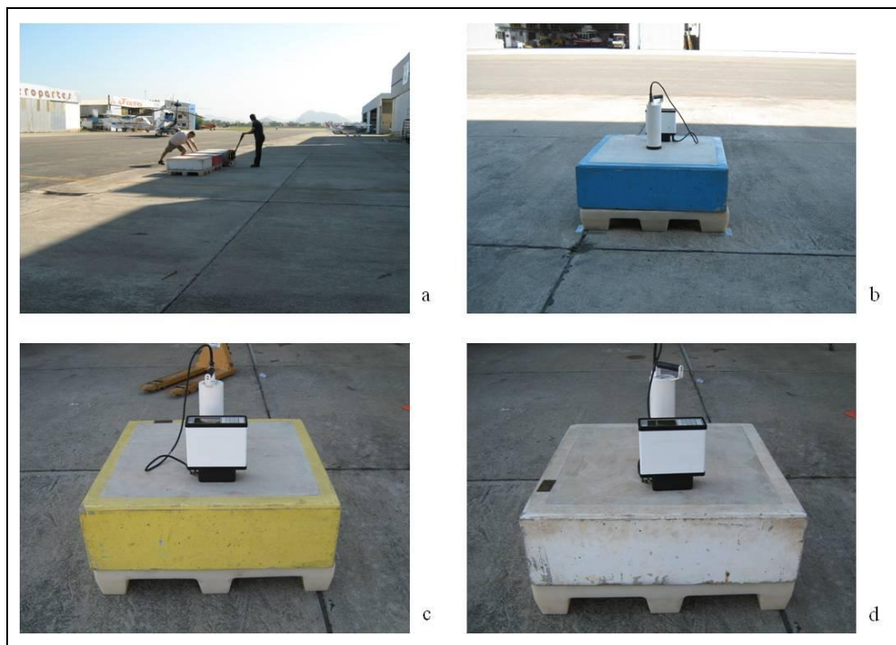
Figura 3.8 – (a) Calibração do gamaespectrômetro realizada na Empresa LASA Engenharia e Prospecção S.A. (b) Bloco de urânio, (c) tório e (d) background .
