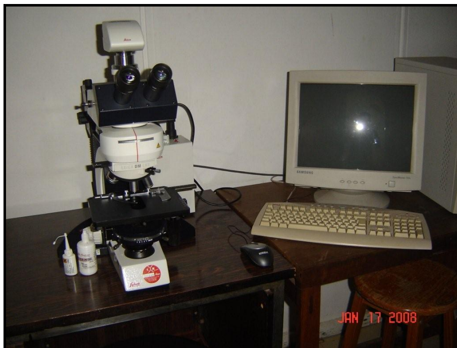
Figura 4.12: Sistema utilizado para aquisição de imagens em microscopia.
