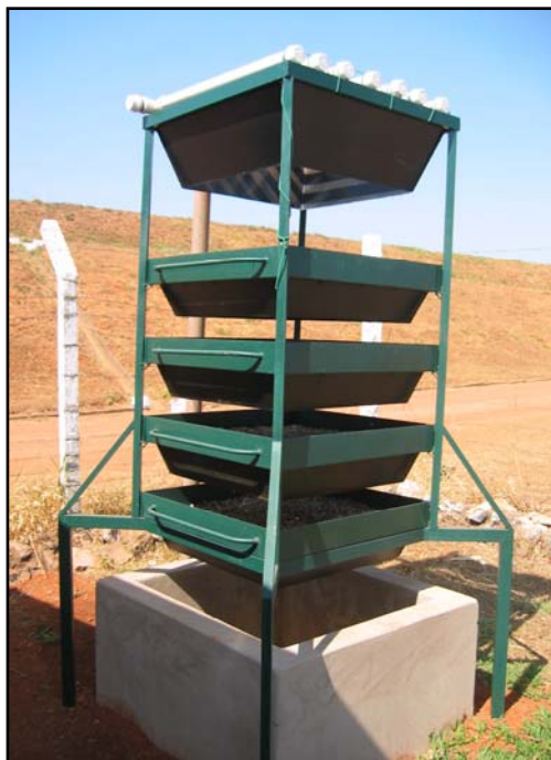
Figura 4.8: Vista geral do sistema de bandejas aeradas instalado na UPS.
