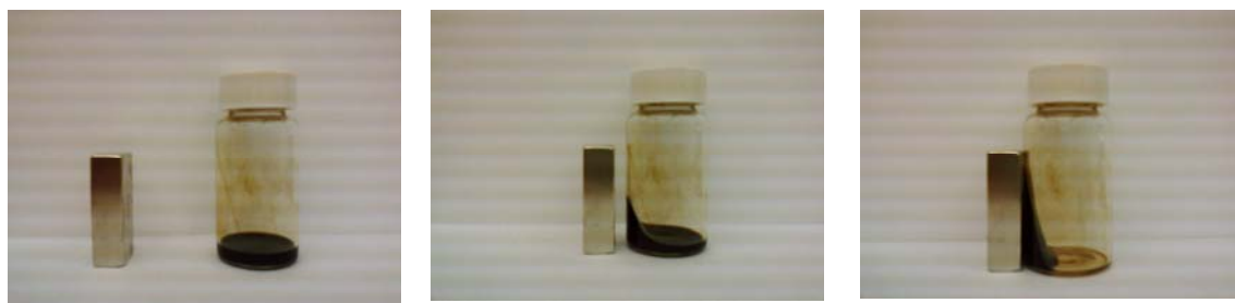
Figura 4.26 Comportamento do FM gerado com as NPMs obtidas em \text{BMI.NTf}_2 e dispersas em hexano na presença de um magneto de Nd.
