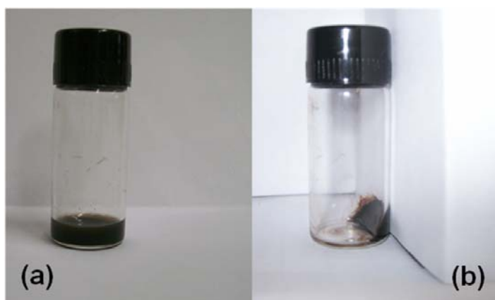
Figura 4.11 Comportamento de uma amostra de \text{CoFe}_2\text{O}_4 dispersa em \text{BMI.BF}_4 na presença de um campo magnético.
