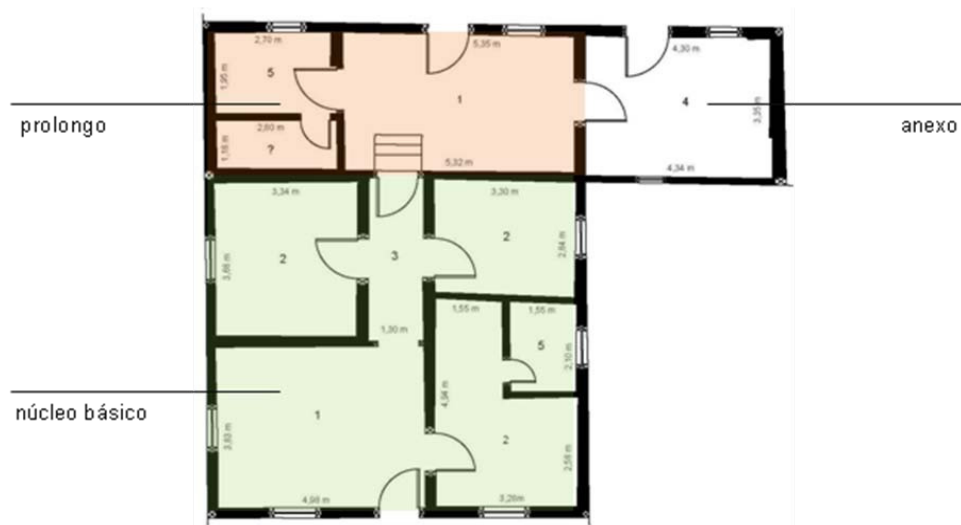
Figura 309 - Planta baixa da morada da Fazenda Sobradinho II, destacados núcleo básico, prolongo e anexo.
