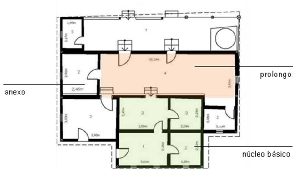
Figura 247 - Planta baixa da morada da Fazenda Saco Grande I, destacados núcleo básico, prolongo e anexo.
