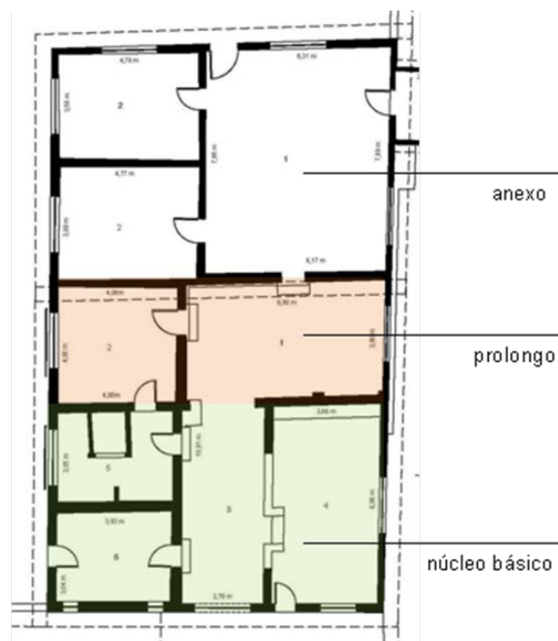
Figura 167 - Planta baixa da morada da Fazenda Desterro, destacados núcleo básico, prolongo e anexo.
