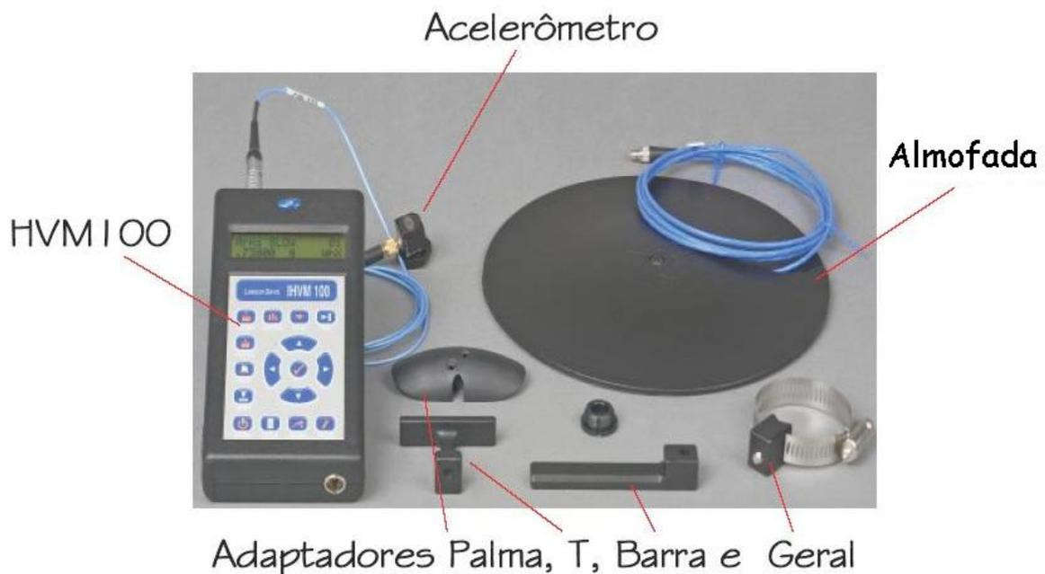
**Figura 3.3** – Acessórios de configuração do aparelho HVM 100 (GROM, 2009).
