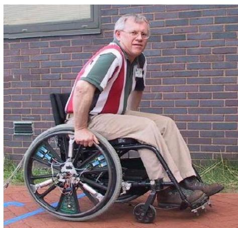
**Figura 3.7** – Acelerômetro instalado na cadeira de rodas (COOPER *et al.*, 2002).
