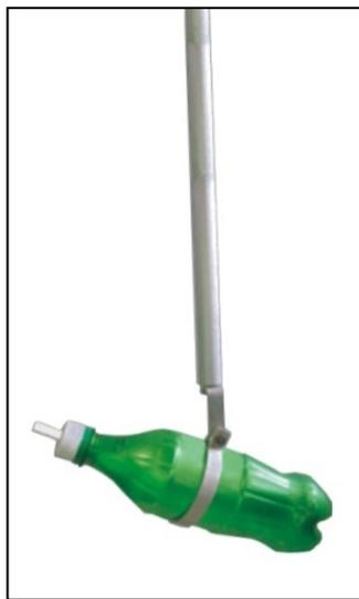
Figura 2.7 – Amostrador de profundidades integradas (modificado) para coleta de água e sedimento em suspensão nos sistemas aquáticos.
