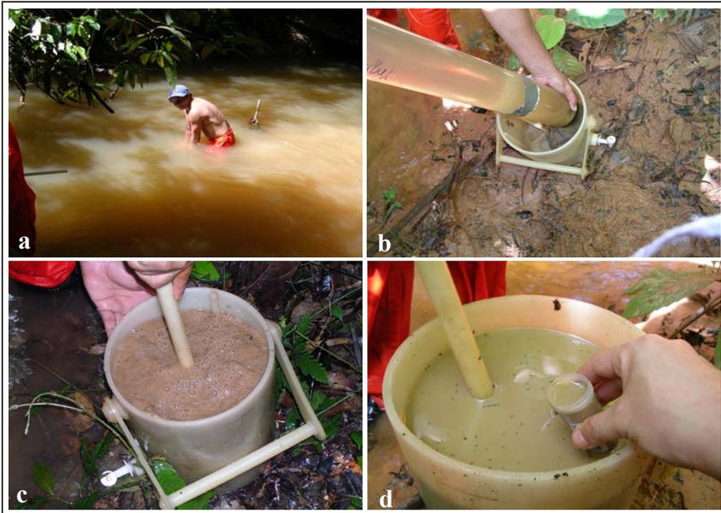
Figura 2.6 – Coleta de sedimento do leito para a estimativa do índice de assoreamento (IA) dos igarapés. Coleta no igarapé (a); despejo dos primeiros 25 cm de sedimento no agitador (b); agitação do sedimento com água do igarapé (c); e retirada de uma sub-amostra de 50 ml (d).
