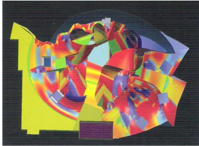
Figura 3.18. Análises Gaussianas do Walt Disney Concert Hall, Sala dos Fundadores. Fonte: KOLAREVIC, 2003, p. 114.
