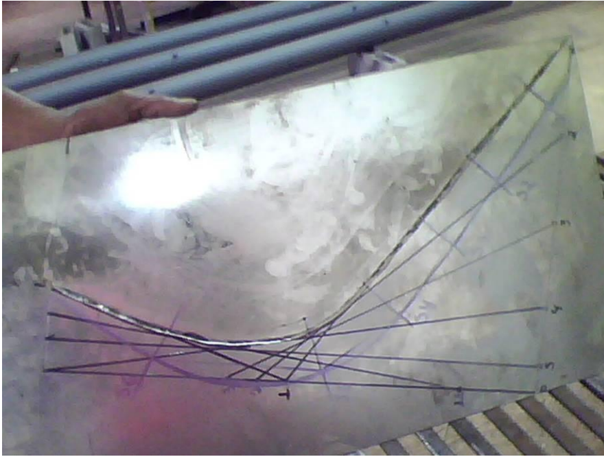
Figura 7.5. Corte na chapa para a fabricação manual. Fonte: MORAIS, H. R. A., 2010.
