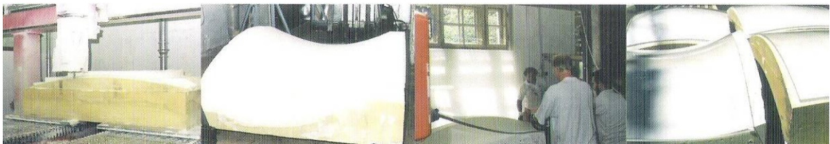
Figura: 4.6. Fabricação de moldes para os vidros do “Bubble”. Fonte: KOLAREVIC, 2003, p.
