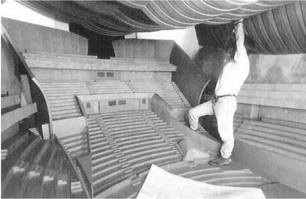
Figura 4.12: Modelo em escala reduzida, usado nos testes acústicos. (GERACE; GEHRY; WHITE; MUDFORD, 2009, p. 123.).
