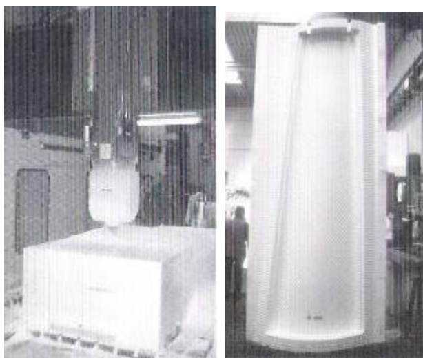
Figura 4.17. Usinagem dos blocos pré-moldados das Torres Düsseldorf. Fonte: (KOLAREVIC, 2005, p. 108.)
