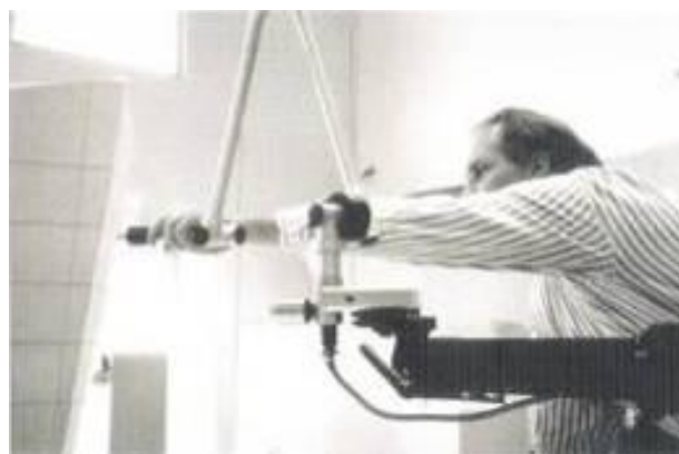
Figura 4.13. Braço digitalizador usado para marcar os pontos racionais. (KOLAREVIC, 2003, p. 106.)
