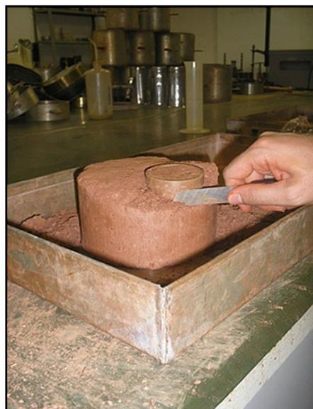
Figura 3.5 – Moldagem dos corpos de prova para o ensaio de sucção após compactação semi-estática
