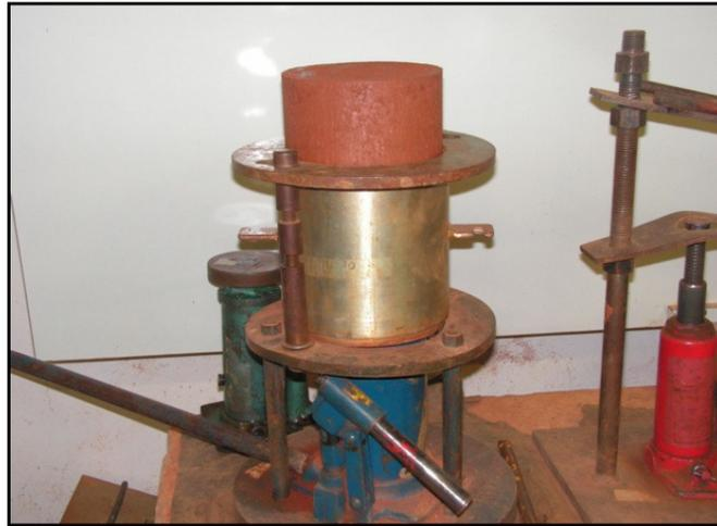
Figura 3.4 – Extração do corpo-de-prova compactado.
