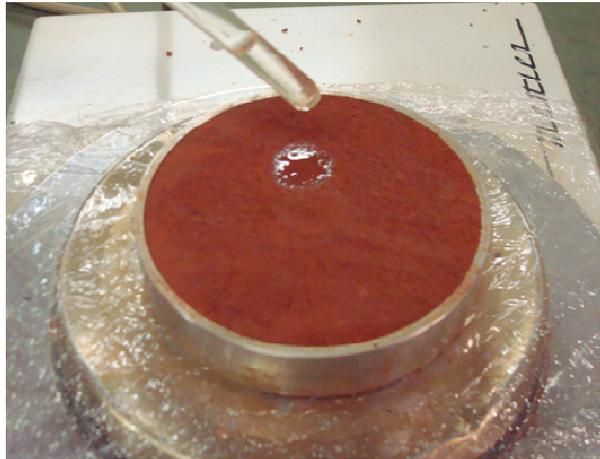
Figura 3.7 – Umedecimento por gotejamento de água destilada.
