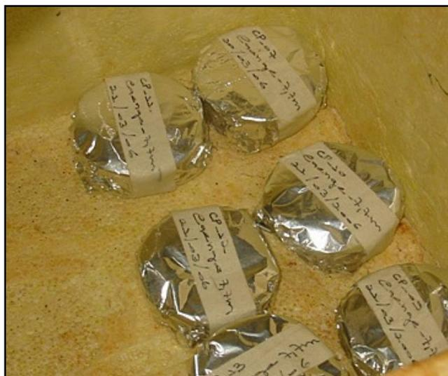
Figura 3.9 – Corpos de prova identificados e lacrados na caixa de isopor.
