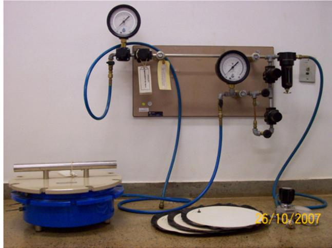
Figura 2.6 – Câmara de Richards conectada ao sistema de pressão.
