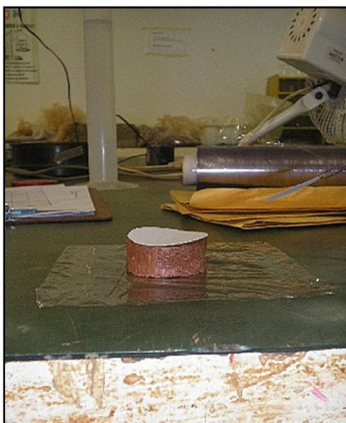
Figura 3.8 – Papel filtro e o corpo-de-prova moldado
