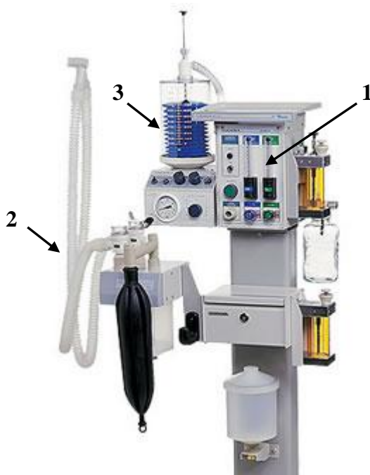
Figura 1 – Aparelho de anestesia, com os três componentes básicos: Secção de fluxo contínuo (1), respirador (2) e sistema circular respiratório (3).
