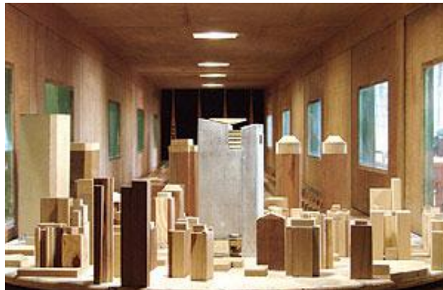
Figura 17 – Modelo rígido: ensaio de edifício e entorno.
