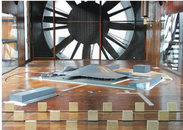
Figura 16 – Modelo reduzido de um projeto e o túnel de vento.
