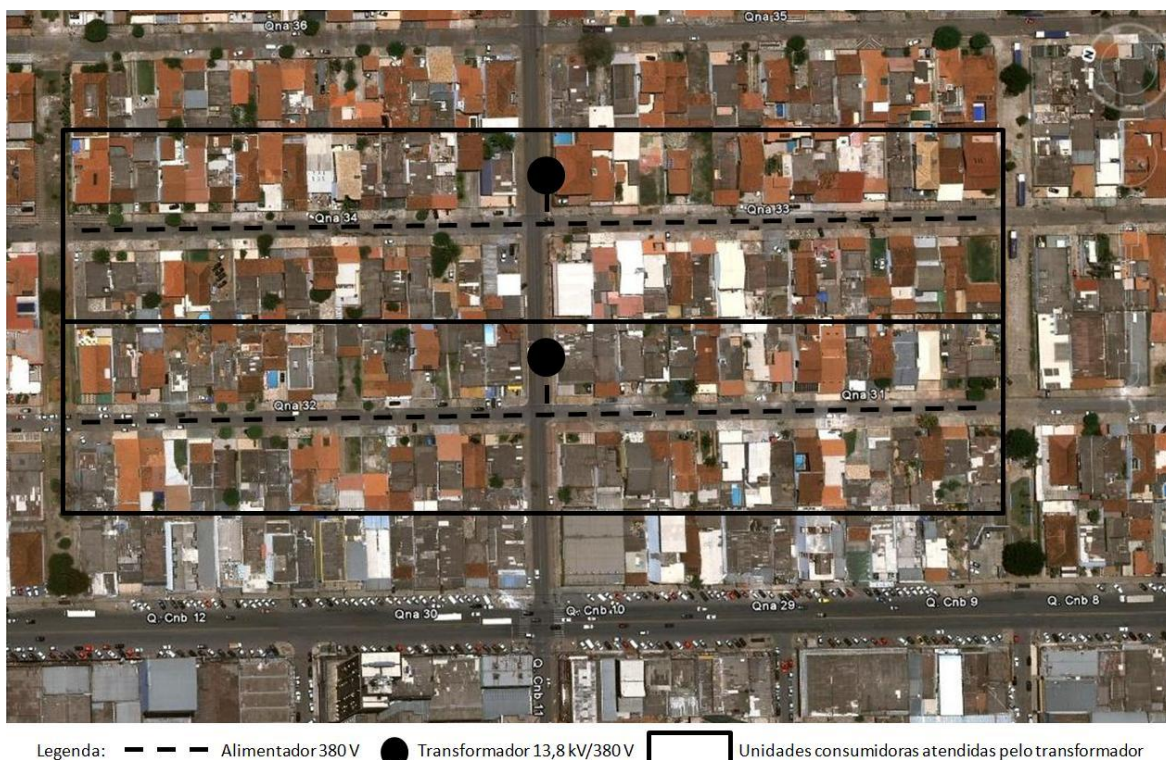
Figura 4.13 – Detalhe do alimentador de baixa tensão, onde o transformador atende às unidades consumidoras de duas quadras, de ambos os lados da rua.
