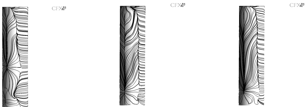
Figura 4.7: Linhas de cisalhamento médias à vista oblíqua esquerda do cilindro - Da esquerda para a direita - URANS, DES e grandes escalas
