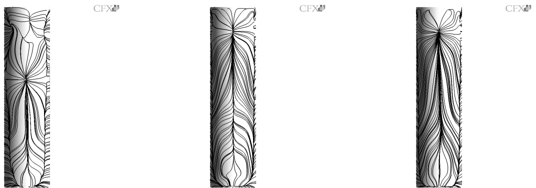
Figura 4.6: Linhas de cisalhamento médias a jusante do cilindro - Da esquerda para a direita - URANS, DES e grandes escalas
