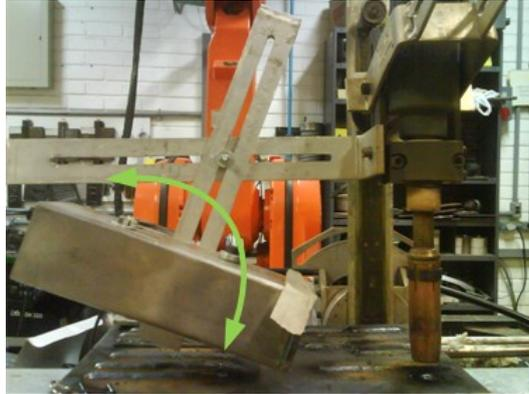
Figura 3.28: Montagem do suporte e a possível falha no posicionamento
