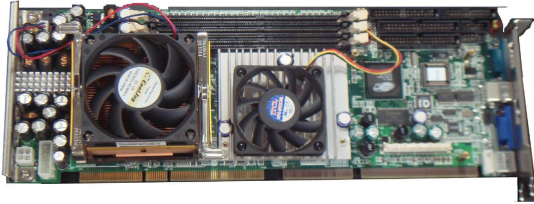
Figura B.3: Placa **PICMG** note o nível de integração
