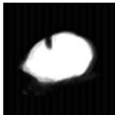
Figura 2.10: Exemplo de uma poça de solda
