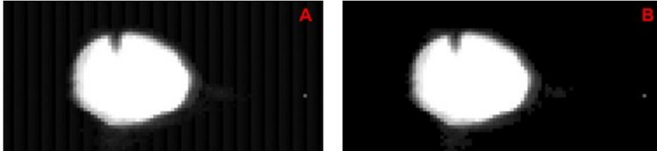
Figura 3.18: Aplicação do filtro *threshold* a fim de retirar o ruído de fundo
