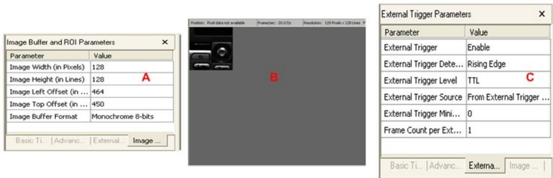
Figura 3.8: Configuração dos parâmetros como **ROI** e *trigger*
