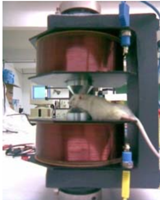
Figura 3-4 - Foto mostrando o posicionamento de um animal no centro da bobina de Helmholtz.
